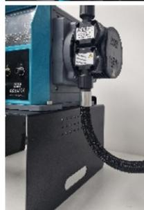
7. 检查软管的整个长度和路线走向, 确保其未扭曲、扭结或与自身(例如, 在绕圈时)或其他表面(例如, 接口孔边缘或架子)发生摩擦。
