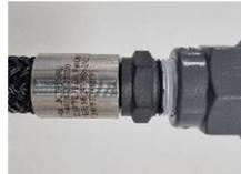
5. 清除流体管路母接头上残留的任何 PTFE 胶带。检查母接头以确保其适用于更换软管接头套件
