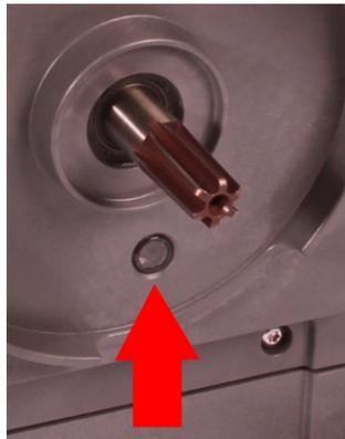
检查泄漏检测传感器和驱动轴是否干净，上面是否存在工艺化学品。如果发现任何化学残留物的证据，请让泵停止运行，然后联系当地的 Watson-Marlow 代表以寻求建议。
