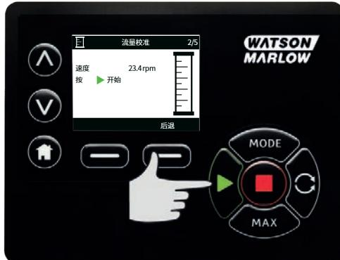
按 **STOP(停止)**，停止泵送用于校准的流体。
