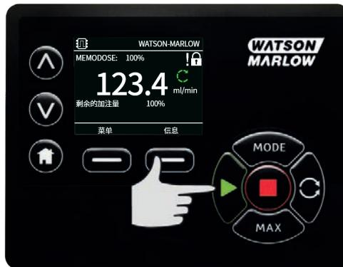
若分装的加注量与所需量不同，可调整主加注量，调整限值为 50% 至 150%。使用  $\wedge/\vee$  键改变比例。新的加注量将以百分比的形式显示于主屏幕上。
