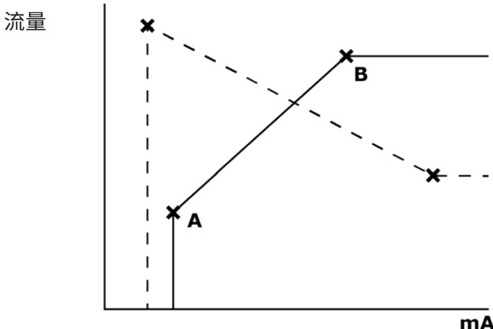
接收到的模拟信号高于 A 点默认值时，泵将运行，并有运行状态输出。
