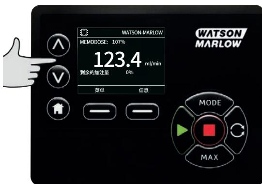
若分装加注量时按下 **STOP(停止)**，泵将立即停止。按下 **START(开始)** 将恢复被中断的加注量，具体取决于“恢复中断加注”[页码 79]的设置。
