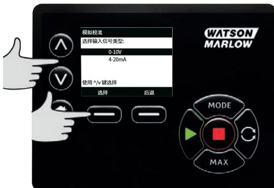
泵给出可手动输入高低电流或电压信号或采用模拟信号输入的选项。此处给出输入电流值的方法，电压信号的输入流程与之相同。
