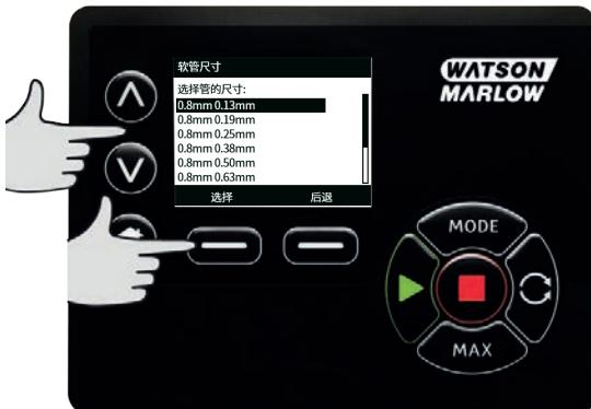
若已选定 LoadSure 软管单元，软管尺寸将显示为压力与内径。
