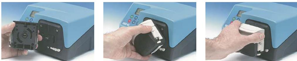
Encaixe a abertura do drive do cabeçote com a extremidade do eixo do drive da bomba. Continue a alinhar o cabeçote até que a baioneta encaixe com a base. Gire o cabeçote no sentido horário até travar na posição vertical.
