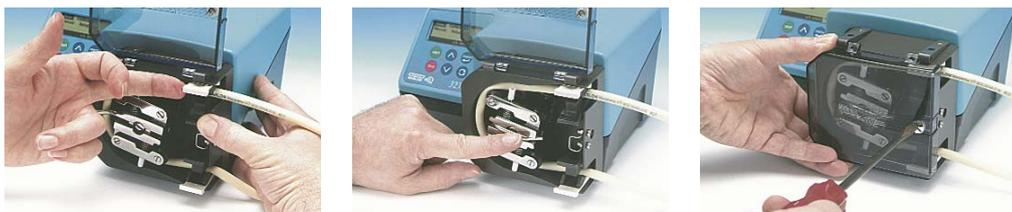
As presilhas da mangueira podem servir para mangueiras de diâmetros variados empurrando ou puxando as barras dentro da presilha. Configure as presilhas para aplicar o mínimo de pressão necessária à mangueira.
