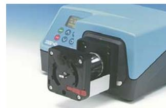
Encaixe a abertura do drive do cabeçote com a extremidade do eixo do drive da bomba. Continue a alinhar o cabeçote até que a baioneta encaixe com a base. Gire o cabeçote no sentido horário até travar na posição vertical.
