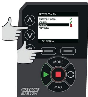
ABILITA le impostazioni di sicurezza per l'Utente 2 visualizza la schermata di inserimento del PIN per l'Utente 2. Per definire un PIN a quattro cifre per l'Utente 2, usare i tasti  $\wedge$  /  $\vee$  per selezionare ogni cifra da 0 a 9. Una volta raggiunta la cifra desiderata, premere il tasto **CIFRA SUCCESSIVA**. Dopo aver selezionato la quarta cifra premere **INVIO**.
