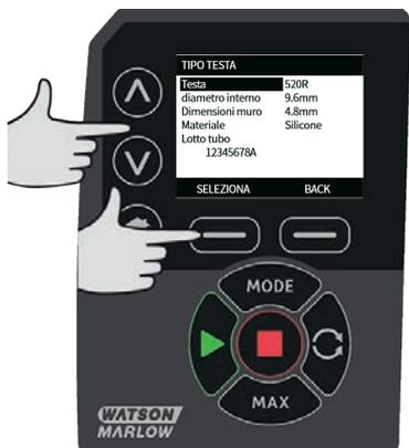
Usare i tasti  $\wedge$  /  $\vee$  per spostare la barra di selezione sul materiale del tubo da usare e premere **SELEZIONA**.
