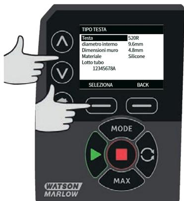
Usare i tasti  $\wedge$  /  $\vee$  per spostare la barra di selezione sulle dimensioni del tubo da usare e premere **SELEZIONA**.
