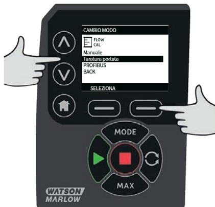
Con i tasti  $\wedge$ / $\vee$ , inserire il limite di portata massimo e premere **ENTER**.
