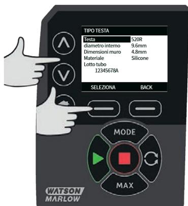
Usare i tasti  $\wedge$  /  $\vee$  per spostare la barra di selezione sul tipo di testa pompa desiderato e premere **SELEZIONA**.
