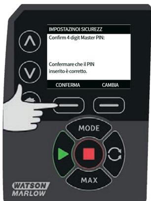
La schermata successiva verrà visualizzata per indicare che il PIN Master è stato applicato per accedere a tutte le funzioni. Premere **SUCCESSIVO** per abilitare l'accesso a una funzione specifica per l'Utente 1 e l'Utente 2.
