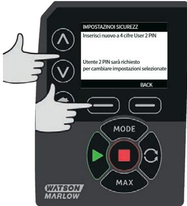
Per definire la funzione consentita, usare i tasti  $\wedge$  /  $\vee$  per selezionare la funzione e premere **ABILITA**. Il PIN dell'Utente 2 consente l'accesso solo alle funzioni abilitate. Per disattivare una funzione, evidenziare la funzione abilitata e premere **DISABILITA**. Quando le funzioni richieste sono state abilitate, premere **TERMINA**.
