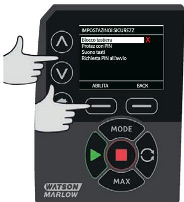
Una volta bloccata, apparirà la schermata seguente ogni volta che viene premuto un tasto. Per sbloccare la tastiera premere contemporaneamente i due tasti di **SBLOCCAGGIO**.
