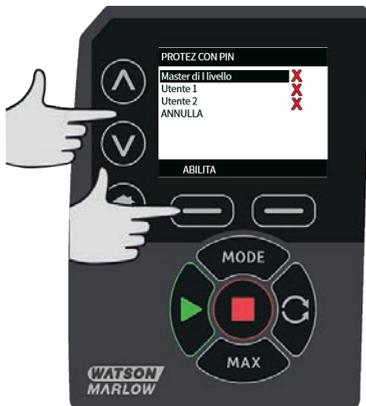
ABILITA le impostazioni di sicurezza per l'Utente 1 visualizza la schermata di inserimento del PIN per l'Utente 1. Per definire un PIN a quattro cifre per l'Utente 1, usare i tasti  $\wedge$  /  $\vee$  per selezionare ogni cifra da 0 a 9. Una volta raggiunta la cifra desiderata, premere il tasto **CIFRA SUCCESSIVA**. Dopo aver selezionato la quarta cifra premere **INVIO**.
