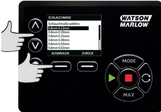
Bei LoadSure Schlauchelementen wird unter Schlauchgröße der Druck und der Innendurchmesser angezeigt.
