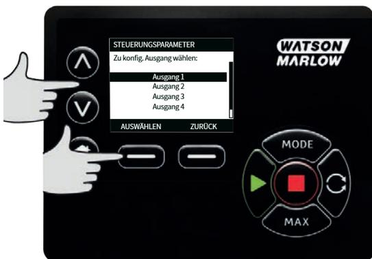
Über die  $\wedge$  /  $\vee$  Tasten auf **AUSWÄHLEN** gehen und den für den gewählten Ausgang gewünschten Status der Pumpe bestimmen. Der Haken zeigt die aktuelle Einstellung an.
