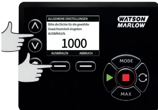
Über die  $\wedge$  /  $\vee$  Tasten den Wert für das spezifische Gewicht eingeben und mit **AUSWÄHLEN** bestätigen.
