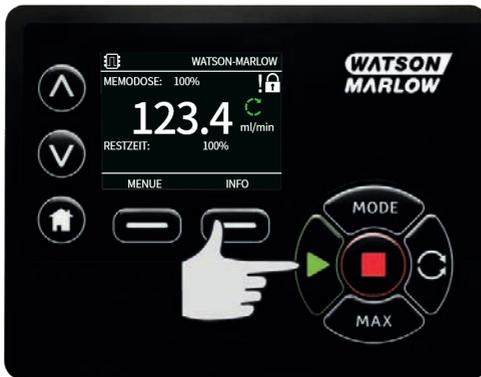
Wenn die abgegebene Dosiermenge vom gewünschten Volumen abweicht, kann der Prozentsatz im Bereich von 50% bis 150% der Referenzmenge (Master-Dosis) angepasst werden. Über die  $\wedge$  /  $\vee$  Tasten lässt sich der Prozentsatz ändern. Der neue Wert der Dosiermenge wird als Prozentsatz am Startbildschirm angezeigt.
