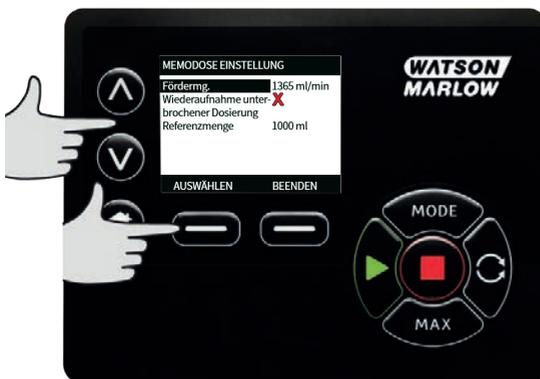
Über die  $\wedge$   $\vee$  Tasten die zu dosierende Fördermenge eingeben und auf **AUSWÄHLEN** drücken.
