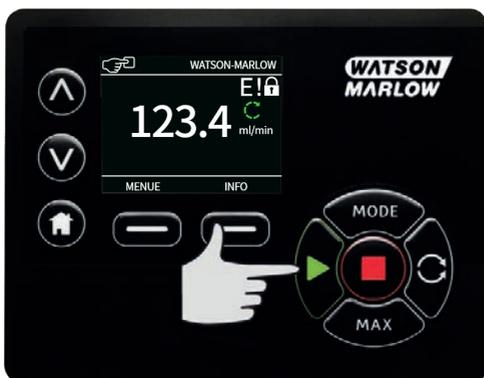
Startet die Pumpe mit der angezeigten aktuellen Fördermenge, und ändert den Hintergrund der Anzeige in grau. Hat keine Auswirkung, wenn die Pumpe bereits in Betrieb ist.
