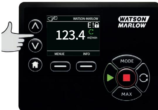
Über die  $\wedge$  und  $\vee$  Tasten lässt sich die Förderleistung erhöhen oder reduzieren.
