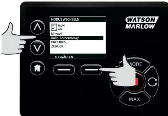
Über die Tasten  $\wedge$  /  $\vee$  die maximale Förderleistung eingeben und mit **EINGABE** bestätigen.
