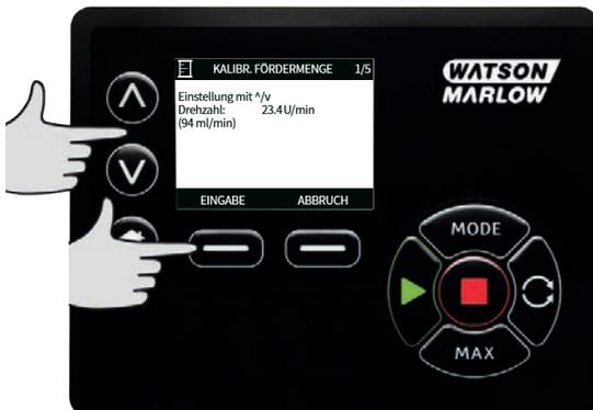
Auf **START** drücken, um ein Volumen an Flüssigkeit für die Kalibrierung zu pumpen.
