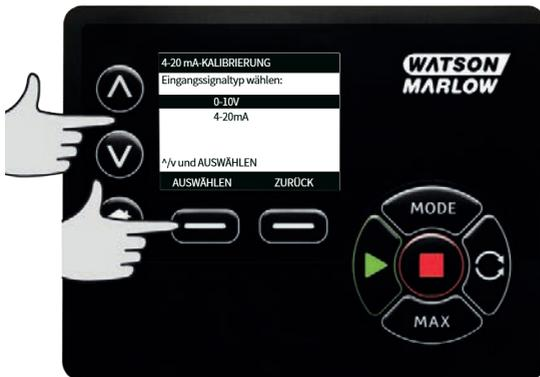
Die Hoch- oder Niederpegelsignale mA bzw. V Signale können wahlweise manuell oder über den analogen Eingang der Pumpe eingegeben werden. Die Eingabe der mA Werte wird hier beschrieben, wobei der Ablauf für die Eingabe der V Signale identisch ist.
