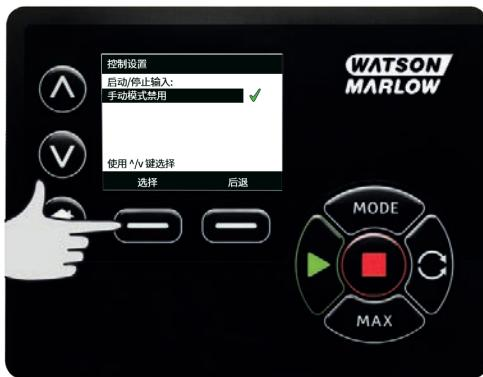
使用  $\wedge/\vee$  键并按下 **SELECT(选择)** 来选择所连接控制硬件的输入逻辑状态。
