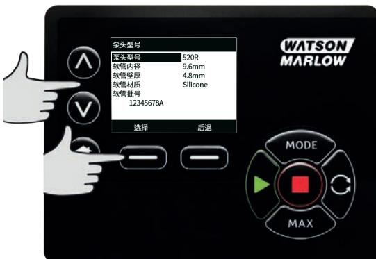
使用  $\wedge/\vee$  键，将选定栏移至所用的软管材质，接着按下 **选择**。
