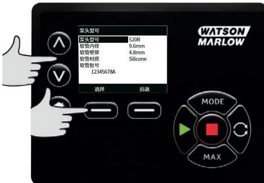
使用  $\wedge/\vee$  键，将选定栏移至所用的软管尺寸，接着按下 **选择**。
