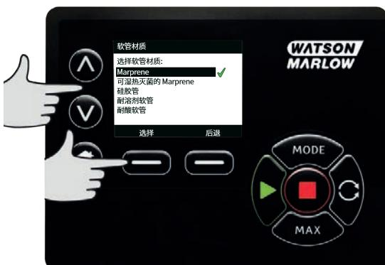
泵头型号屏幕可记录软管批号，以备将来参考。使用  $\wedge/\vee$  键，将选定栏移至**软管批号**，接着按下**选择**。
