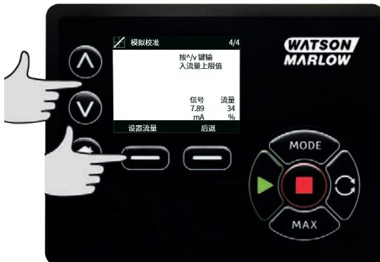
接着进入确认校准已完成的界面。选择**模拟信号**以启动模拟模式，或选择**手动**继续运行手动模式。
