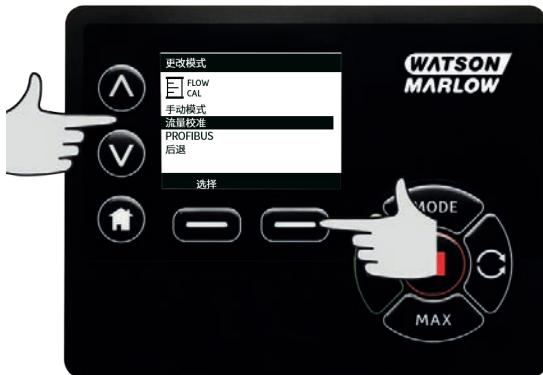
使用  $\wedge/\vee$  键输入最大流量限值，接着按 **ENTER**。
