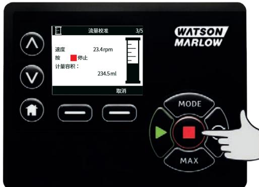
使用  $\wedge/\vee$  键输入实际泵送的流体体积。
