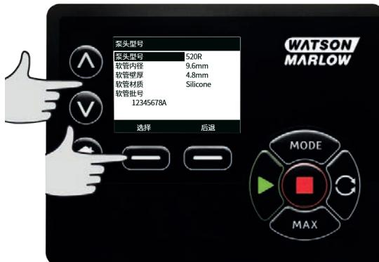
使用  $\wedge/\vee$  键，将选定栏移至所需泵头类型，接着按下 **选择**。
