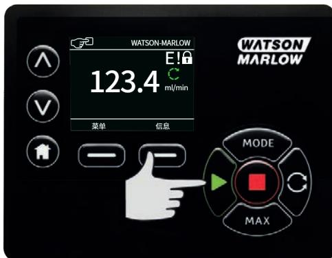
当以显示的当前流量启动泵，显示屏背景将变成灰色。若泵已运行，按此键不起作用。
