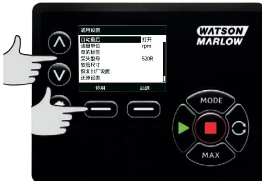
使用  $\wedge/\vee$  键，将选定栏移至 **泵头**，接着按下 **选择**。
