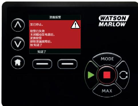
请遵循“软管更换”[页码123]的说明来更换软管或软管单元。
