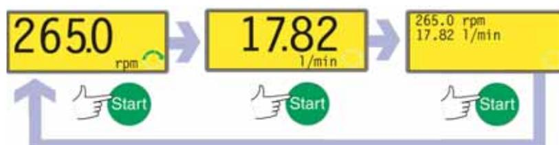
Se a bomba estiver funcionando quando **START** for pressionado, as informações exibidas na tela Manual running passam, na seqüência, para revoluções por minuto, vazão na unidade escolhida (através de uma tela de aviso se a vazão não foi calibrada e se este for o primeiro ciclo desde que a bomba foi ligada), rpm e vazão. Veja o exemplo dado. O padrão pode ser alterado no menu Setup (Veja 16.3 *Visor*).
