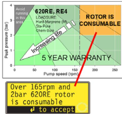
A velocidade padrão de operação desta bomba é de 165 rpm. Pode operar a até 265 rpm. Observe, porém que:
