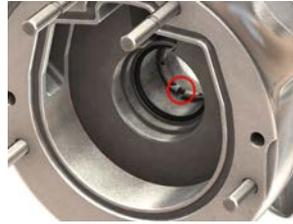
Posez le joint torique sur le diamètre intérieur du carter arrière
