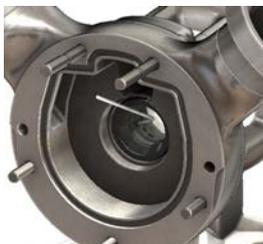
Desserrer les vis de blocage à l'intérieur du joint statique avec l'ensemble ressort monté serré
