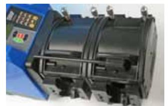
**Remarque:** En présence d'une seconde tête de pompe, la pression maximale de chaque canal ne doit pas dépasser 1 bar (14,5 psi).
