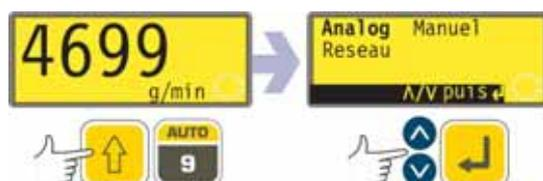
tourne à la vitesse spécifiée par un signal analogique ou un signal RS232 communiqué à la pompe, et dans le sens de rotation indiqué à l'affichage.
