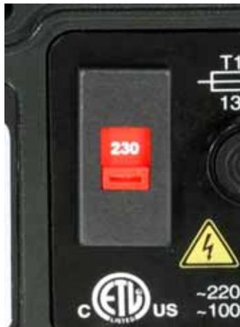
Réglez le dispositif de sélection de tension sur 115 V pour le courant de secteur 100-120 V 50/60 Hz ou 230 V pour le courant de secteur 200-240 V 50/60 Hz. Vérifiez toujours le commutateur de sélection de tension avant d'opérer le raccordement sur secteur.
