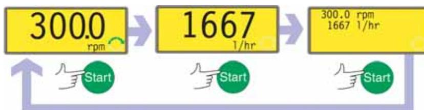
Si la bomba está en funcionamiento cuando se pulsa **START**, la información mostrada en la pantalla principal del modo manual va mostrando secuencialmente revoluciones por minuto, caudal en mililitros por minuto (mediante una pantalla de advertencia si no se ha calibrado el caudal y si este es el primer ciclo desde el encendido), y rpm y caudal. A continuación, puede ver un ejemplo.
