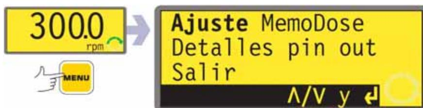
El menú principal ofrece cuatro opciones: **Configuración**, **MemoDose**, **Detalles de clavijas de salida** y **Salir**. Use las teclas **ARRIBA** y **ABAJO** para seleccionar una opción. Presione la tecla **ENTER** para confirmar su decisión.
