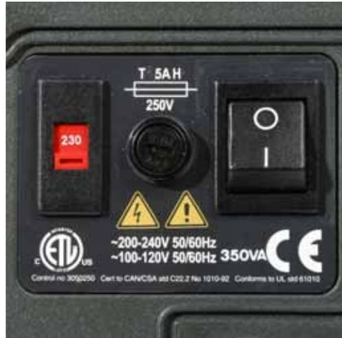
**Fusible de línea de entrada:** fusible retardado del tipo T5A H, de 250 V y 20 mm, ubicado en un portafusible en el centro de la placa de conmutación en la parte posterior de la bomba.
