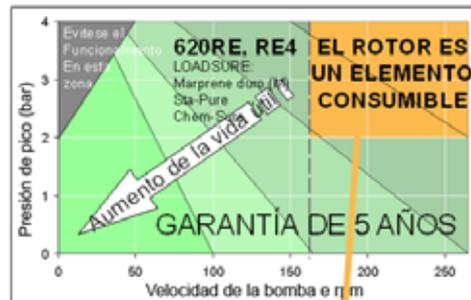
Superar 165rpm y 2bar con rotor 620RE es posible
