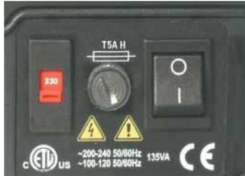
**Fusible de línea de entrada:** fusible retardado del tipo T5A H, de 250 V y 20 mm, ubicado en un portafusible en el centro de la placa de conmutación en la parte posterior de la bomba.
