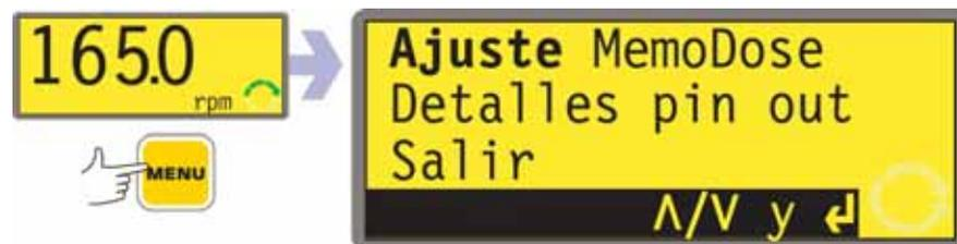
El menú principal ofrece cuatro opciones: **Configuración**, **MemoDose**, **Detalles de Clavijas de Salida** y **Salir**. Use las teclas **ARRIBA** y **ABAJO** para hacer una selección. Presione la tecla **ENTER** para confirmar su decisión.
