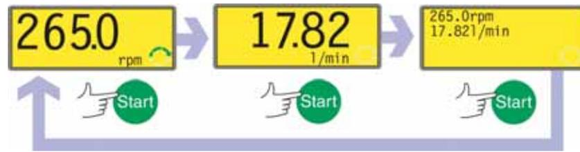
Si la bomba está en funcionamiento cuando se pulsa **START**, la información mostrada en la pantalla principal del modo manual va mostrando secuencialmente revoluciones por minuto, caudal en mililitros por minuto (mediante una pantalla de advertencia si no se ha calibrado el caudal y si este es el primer ciclo desde el encendido), rpm y caudal. A continuación, puede ver un ejemplo.
