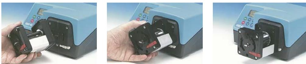
Conecte la ranura del accionamiento del cabezal con el extremo del eje de accionamiento de la bomba. Continúe alineando el cabezal hasta que la bayoneta se conecte con la placa de montaje. Gire el cabezal en sentido horario hasta que se trabaje en posición vertical.
