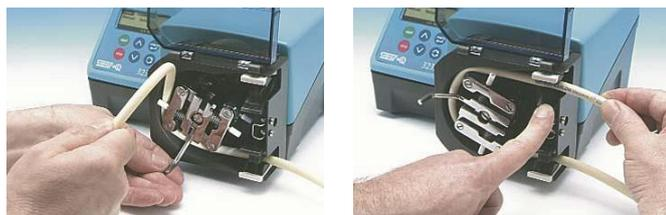
Cuando la manguera haya dado la vuelta a la pista de la bomba, encaje el otro extremo de la manguera en la abrazadera. Compruebe que la manguera se haya asentado con naturalidad contra la pista, para optimizar la vida útil de la manguera. Suelte las abrazaderas y ajuste la manguera, esta si está floja, torcida o estirada.
