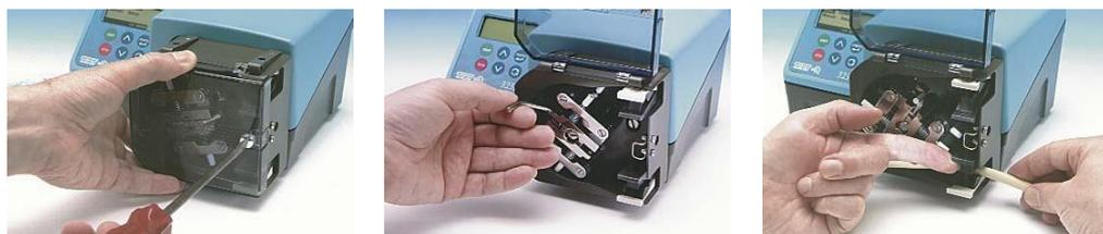
El rotor tiene rodillos guía para la manguera, que traccionan la manguera hacia el cabezal durante la instalación. Gire el rotor con cuidado hasta que las guías recojan la manguera. Siga girando el rotor e inserte la manguera entre las guías.
