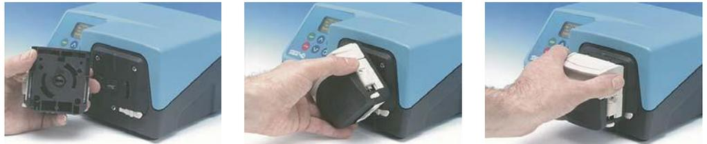
Conecte la ranura del accionamiento del cabezal con el extremo del eje de accionamiento de la bomba. Continúe alineando el cabezal hasta que la bayoneta se conecte con la placa de montaje. Gire el cabezal en sentido horario hasta que se trabaje en posición vertical.
