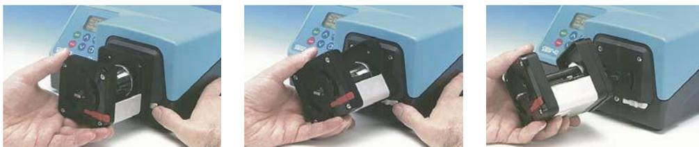
Empuje la palanca de bloqueo hacia atrás y gire el cabezal en sentido antihorario hasta que se separe de la placa de montaje.
