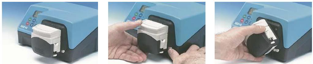
Empuje la palanca de bloqueo hacia atrás y gire el cabezal en sentido antihorario hasta que se separe de la placa de montaje.
