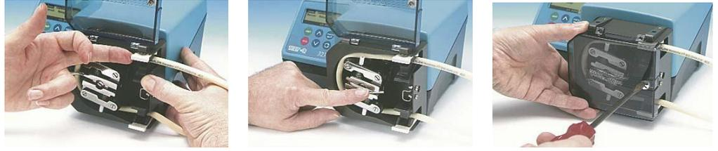
Las abrazaderas pueden alojar diversos diámetros de manguera moviendo hacia adentro o afuera las barras de agarre dentro de la abrazadera. Ajuste las abrazaderas a fin de que apliquen la presión mínima necesaria a la manguera.
