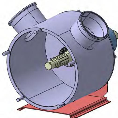
**24 Dismantling „Mechanical Seal System“**
