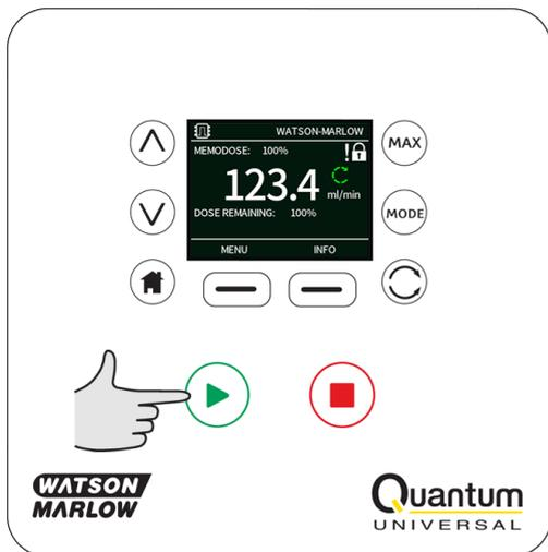
Wenn die abgegebene Dosiermenge vom gewünschten Volumen abweicht, kann der Prozentsatz im Bereich von 1% bis 999% der Referenzmenge (Master Dose) angepasst werden. Über die  $\wedge$  /  $\vee$  Tasten lässt sich der Prozentsatz ändern. Der neue Wert der Dosiermenge wird als Prozentsatz am Startbildschirm angezeigt.
