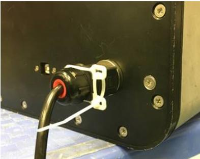
Sicherstellen, dass der Clip am Stromanschluss mit einem Kabelbinder befestigt ist (wie dargestellt) und der Harting Stecker vor Stromzufuhr eingesteckt ist.
