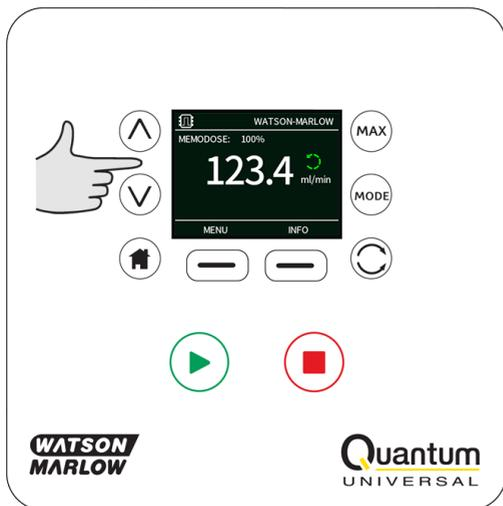
Wenn während des Dosierens **STOP** gedrückt wird, hält die Pumpe an. Über **START** wird die abgebrochene Dosierung wieder aufgenommen oder verworfen, je nach Einstellung in "Abgebrochene Dosierung fortsetzen" auf Seite 63.
