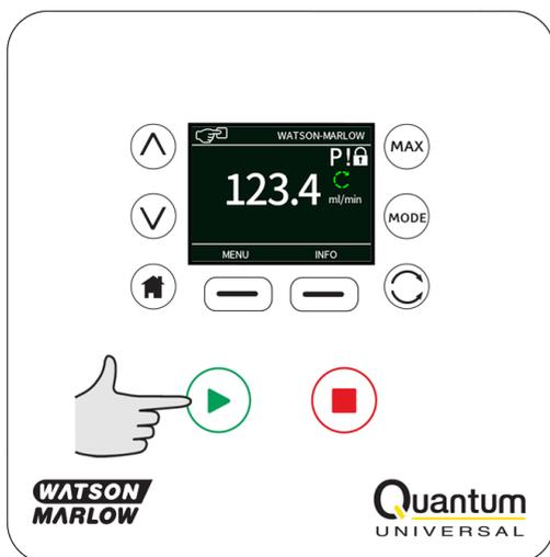
Startet die Pumpe mit der angezeigten aktuellen Fördermenge, und ändert den Hintergrund der Anzeige in grau. Während des Betriebs der Pumpe ist sie wirkungslos.
