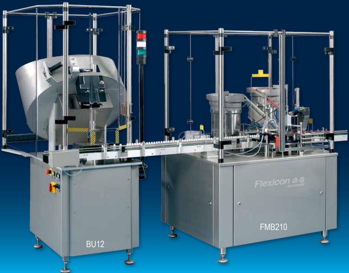
FMB210装备有完备的传感器和校验装置，最大限度的保证操作的正确性以及避免缺瓶对后续灌装/加盖操作所带来的影响。
