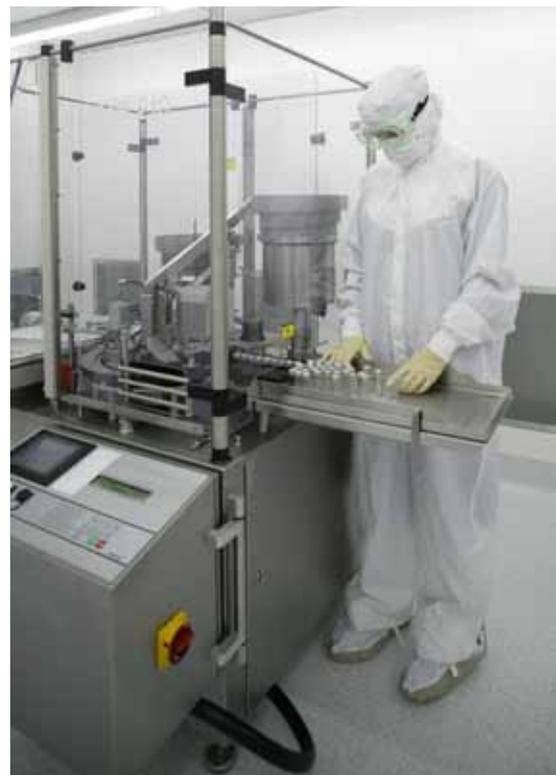
FMB210可以同一个class 100的层流无菌室（LAF）一起供应以为生产提供一个安全的class 100的生产环境。LAF可以直接安装在设备上，也可以根据客户的需求来定制扩展型的LAF，覆盖送瓶区域及收瓶区域。
