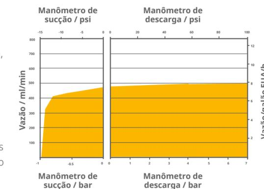
Vazões baseadas no bombeamento de água a 20 °C, com zero de sucção e alturas manométricas
