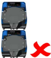
Figura 2 - Impilaggio di pompe
