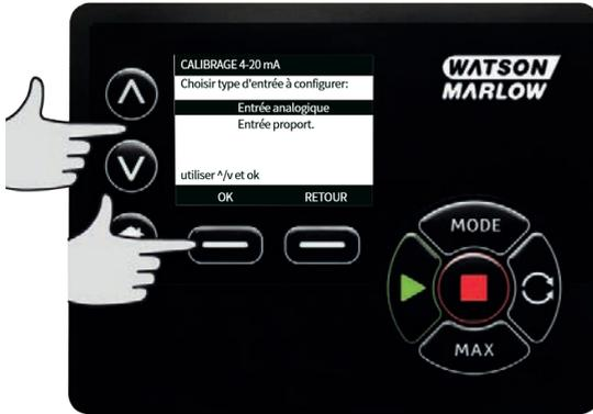
Sélectionnez le type de signal d'entrée à l'aide des touches  $\wedge$  /  $\vee$ , puis appuyez sur **SÉLECTIONNER**.
