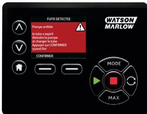
Suivez les consignes énoncées à la section « Remplacement des tubes » sur la page 119 pour remplacer le tube ou l'élément du tube.
