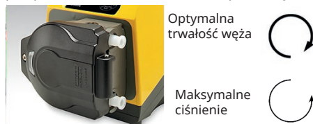
rys. 3 - Kierunek wirnika
