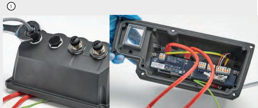
Afbeelding 10 - Aardings scherm voor besturingskabels op de PROFINET® NEMA module
