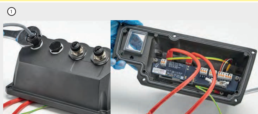
Figure 10 - Jordskærmning af styrekabler på PROFINET® NEMA-modul
