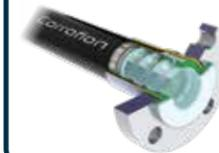
La superficie corrugata del rivestimento interno in PTFE di Corroflon presenta un profilo poco profondo che riduce al minimo la riduzione della portata, mentre la molla di rinforzo nella parete corrugata esterna garantisce la massima resistenza al vuoto e allo strozzamento
