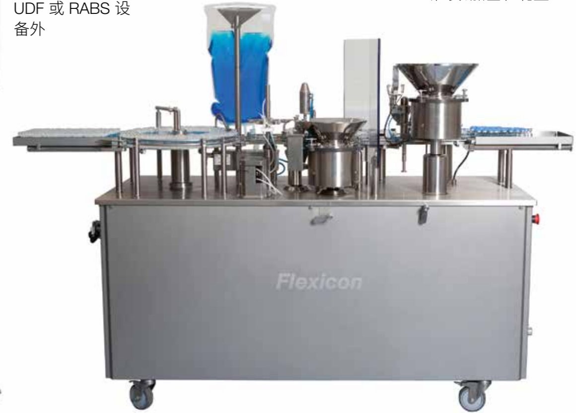
通用型组件, 适合各种规格瓶子的灌装、加塞和轧盖
