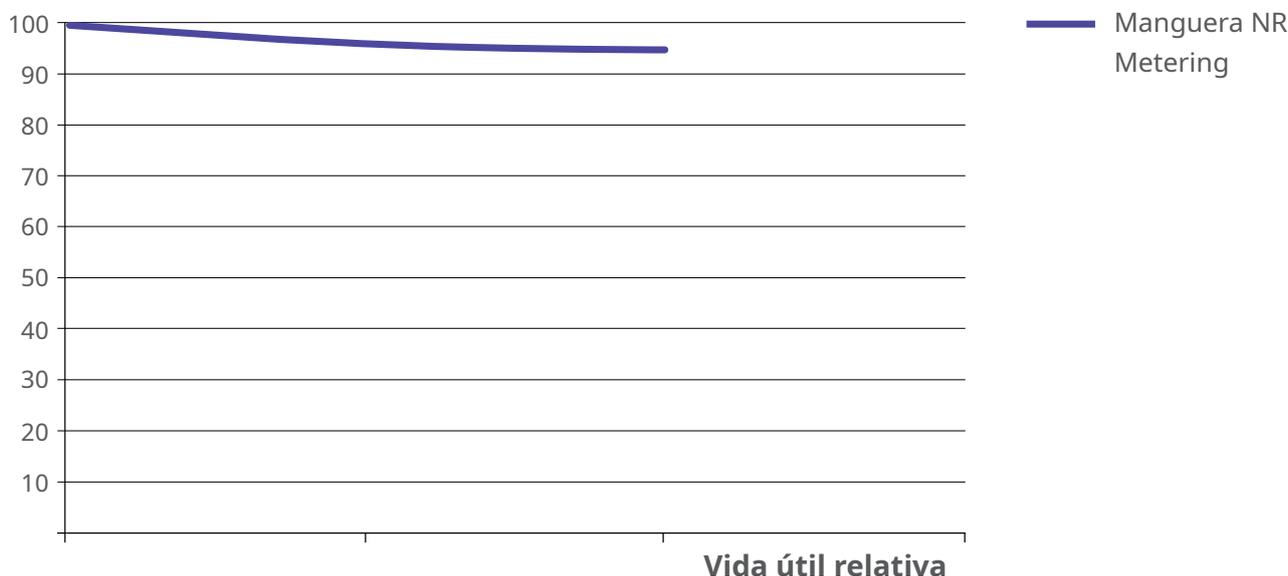
Condiciones normales para la prueba de rendimiento: agua de bombeo a 18 °C (64 °F), 5 bar (73 psi) y 50 rpm
