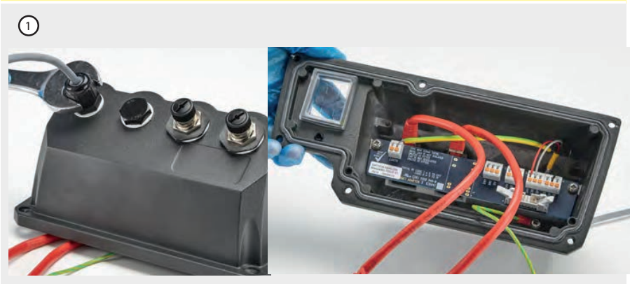
그림 10 -EtherNet/IP™ NEMA 모듈의 제어 케이블 접지 스크린
