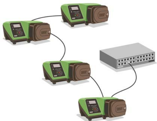
Figura 20 - Topologia della linea
