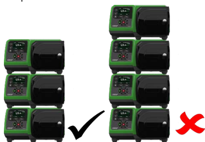
Figura 2 - Impilaggio di pompe
