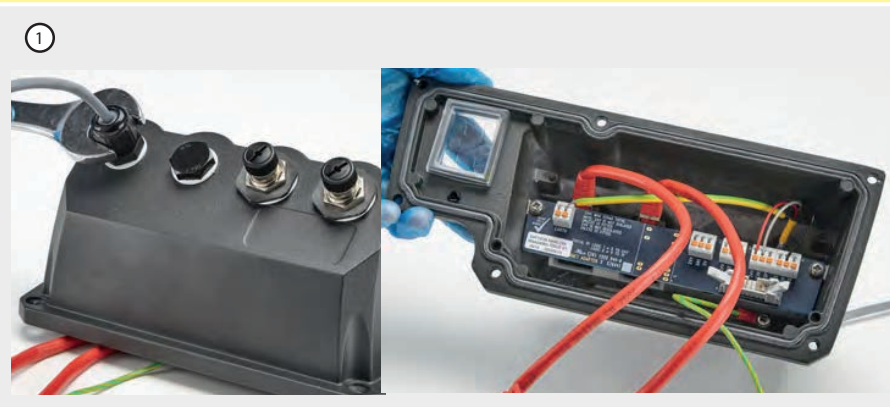
Figura 10 - Schermatura dei cavi di comando sul modulo EtherNet/IP™ NEMA
