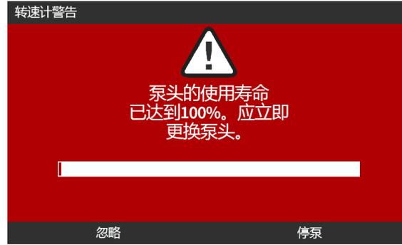
在上述两种红色屏幕的情况下, 泵将始终继续运行。只有按下“停止泵”软键, 泵才会停止。
