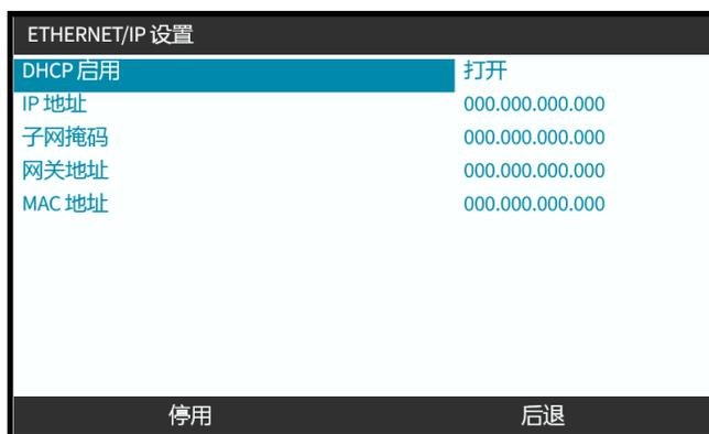
DHCP 可被禁用, 并使用 HMI 手动配置网络参数。这在"16.3.2 程序:使用 HMI 设置 IP 地址" 在本页 160中进行了解释。
