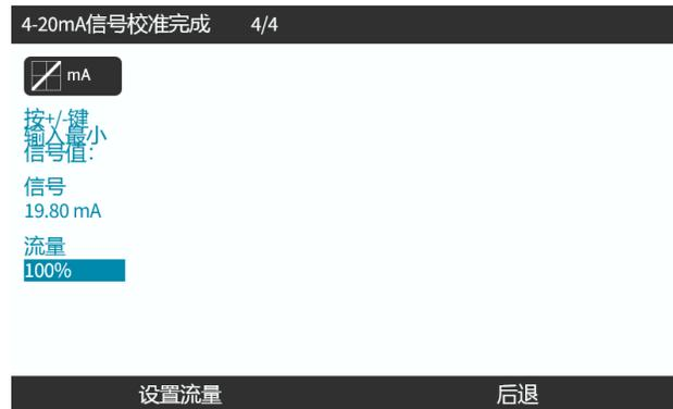
输入所有设置后将显示校准确认屏幕。
