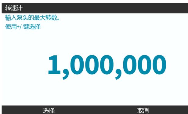
3. 使用 **+/-** 键突出显示要编辑的字符。可用字符:0-9
