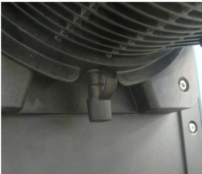
在安装过程中，从开口处取下橡胶帽，以便连接安全溢流口管道，但不要彻底拆卸橡胶帽。
