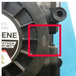
5. 用手将泵头锁定杆锁紧到位。不要使用工具来移动锁定杆。
