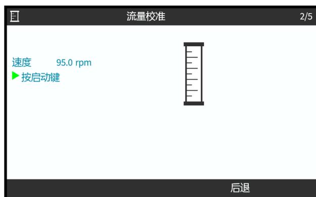
6. 按**停止**以停止泵送用于校准的流体。
