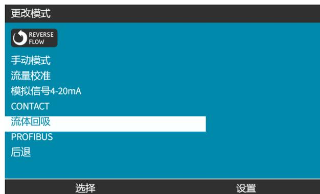
4. 现在将显示说明。将出现一条警告，确保系统设计允许反向流动。如果流体管路安装了单向阀，则无法实现反向流动，而泵就会在管道内积聚过大的压力
