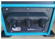
3. 从驱动器上卸下模块盖。不要用工具撬开。确保垫圈被固定在模块盖的凹槽内。
