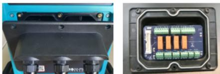
4. 确保预装的电缆密封头正确就位、牢固并安装了防尘帽。
