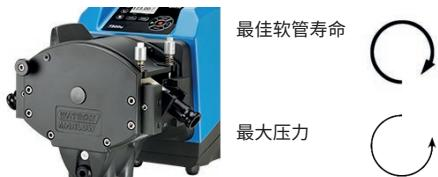
蠕动泵具有自吸性和自密性，防止回流。除如下描述的种类，进出口管路上无须安装阀门。
