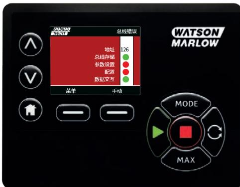
屏幕上将显示“运行”或“停止”，具体取决于 PROFIBUS GSD 文件中用户设置的故障安全功能(见下图)。MODE(模式)按钮可用于访问 PROFIBUS 设置与站点地址。进入菜单后，泵在 PROFIBUS 总线模式下处于静止状态，但没有通信。处于不活动状态 5 分钟后，泵将回到主屏幕，并丢弃所有未保存的更改，若仍无通信，则会显示总线错误屏幕。
