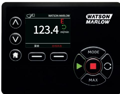
MODE( 模式 ) 按钮可用于访问 PROFIBUS 设置与站点地址。进入菜单后，手动模式下，泵在技术上处于静止状态，但无 PROFIBUS 通信。处于不活动状态 5 分钟后，泵将返回手动模式主屏幕，并丢弃所有未保存的更改，若仍无通信，则会出现红色 P 符号。关于 PROFIBUS 通信错误的详细信息，请参见 "PROFIBUS 通信错误" [ 页面码 46 ] 部分。
