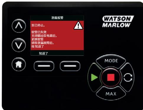
请遵循“软管更换”[页码 81]的说明来更换软管或软管单元。
