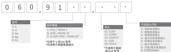
\*对于 KROHNE 流量传感器，须配备特殊的 069.911F.100 以太网防水模块 (630F) IP66 NEMA 4X，该模块也可与 IP31 泵配套使用
