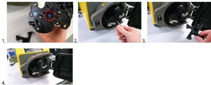
确保已安装转子隔圈。
