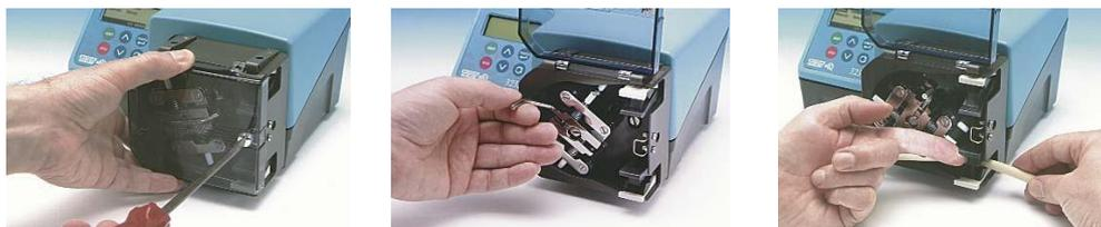
Der Rotor verfügt über Schlauchführungsrollen, die den Schlauch während des Einlegens in den Pumpenkopf ziehen. Drehen Sie den Rotor vorsichtig, bis die Schlauchführungen den Schlauch greifen. Drehen Sie den Rotor weiter, und führen Sie den Schlauch durch die Führungen.
