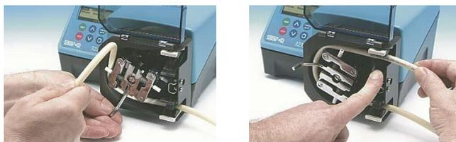
Wenn der Schlauch auf der anderen Seite des Schlauchbetts raus kommt, stecken Sie das andere Ende des Schlauchs in die Klemme. Prüfen Sie, ob der Schlauch ordnungsgemäß im Schlauchbett liegt, um eine optimale Lebensdauer des Schlauchs zu gewährleisten. Lösen Sie die Klemmen, und richten Sie den Schlauch neu aus, wenn er locker, verdreht oder gedehnt ist.
