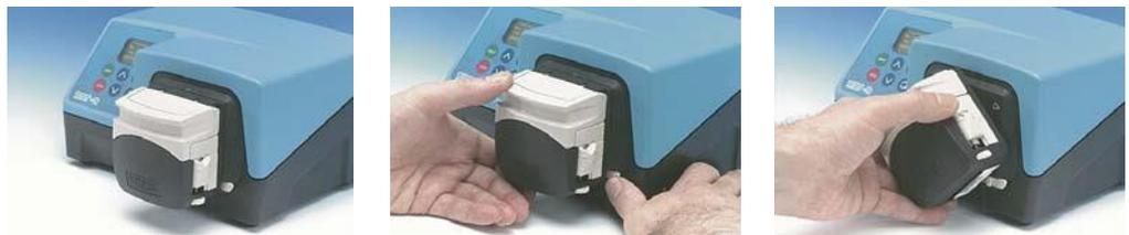
Drücken Sie den Verriegelungshebel zurück, und drehen Sie den Pumpenkopf gegen den Uhrzeigersinn, bis er sich von der Montageplatte löst.
