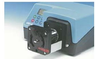
Stecken Sie den Schlitz am Pumpenkopftrieb auf das Ende der Pumpenantriebswelle. Richten Sie den Pumpenkopf weiter aus, bis die Bajonettbefestigung mit der Montageplatte einrastet. Drehen Sie den Pumpenkopf im Uhrzeigersinn, bis er in einer aufrechten Position einrastet.
