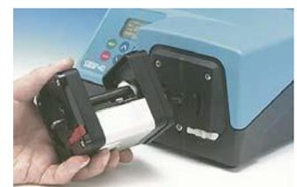
Drücken Sie den Verriegelungshebel zurück, und drehen Sie den Pumpenkopf gegen den Uhrzeigersinn, bis er sich von der Montageplatte löst.
