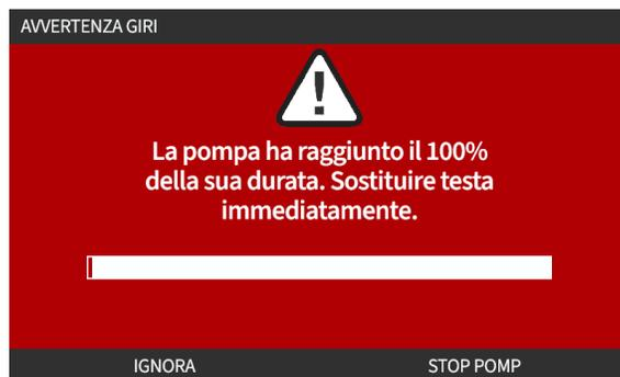
In entrambi i casi di schermata rossa di cui sopra, la pompa continuerà a funzionare. La pompa si ferma solo quando viene premuto il tasto a schermo STOP PUMP (ARRESTA POMPA).
