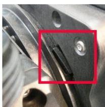
7. Controllare che la freccia in rilievo sulla testa sia rivolta verso l'alto.
