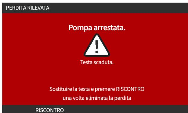
Ai fini della verifica dell'alimentazione della pompa, questo messaggio indica che la pompa riceve corrente.
