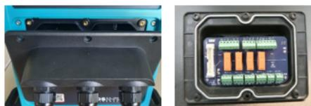
4. Assicurarsi che i passacavi preinstallati siano correttamente posizionati, fissati e dotati di tappi protettivi antipolvere.
