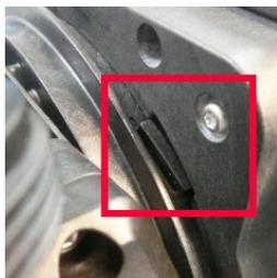
4. Controllare che la freccia in rilievo sulla testa sia rivolta verso l'alto.
