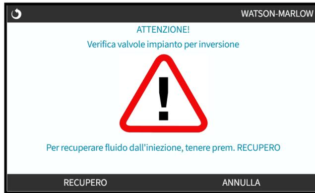
5. Tenere premuto **RECOVER**
