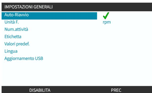
5. Per impostare le unità di misura della portata visualizzate per tutte le schermate della pompa.
