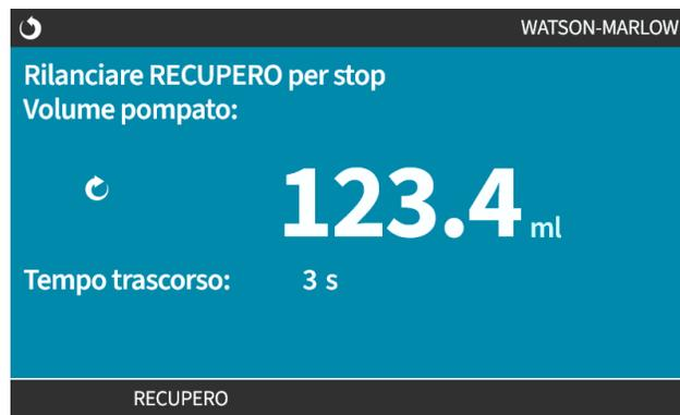
6. Rilasciare **RECOVER**
