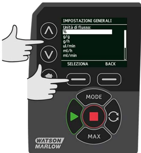
Se viene selezionata un'unità di portata di massa, sarà necessario inserire la gravità specifica del fluido. Verrà visualizzata la schermata seguente.
