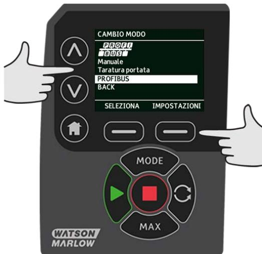
Usare i tasti  $\wedge$  e  $\vee$  per modificare l'indirizzo della stazione, nella gamma compresa tra 1 e 125 (126 è l'indirizzo stazione predefinito). Premere **TERMINA** per impostare l'indirizzo della stazione, oppure **SUCC** per attivare/disattivare la comunicazione PROFIBUS.
