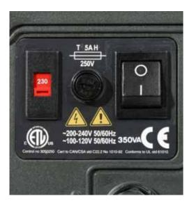
**Fusível de linha de entrada**: fusível de retardo tipo T5A H 250 V 20 mm, localizado na caixa de fusíveis no centro da placa do interruptor, na parte posterior da bomba.
