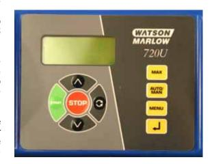
START: liga a bomba na velocidade e direção exibidas no visor. O símbolo de rotação é animado para confirmar que a bomba está em operação.
