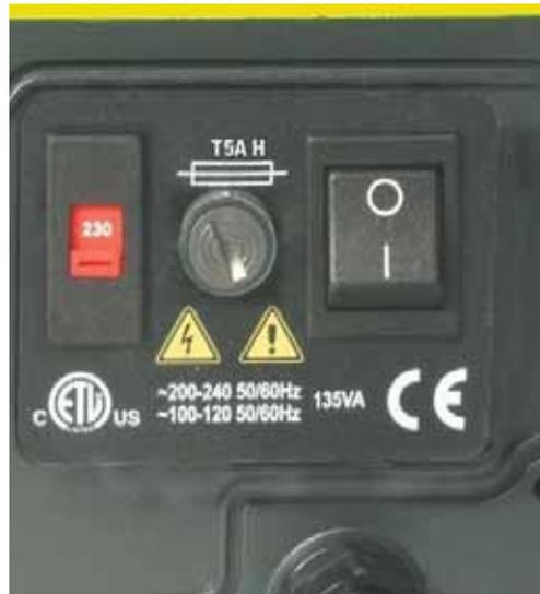
**Fusível de linha de entrada:** fusível de retardo tipo T5A H 250V V 20 mm, localizado na caixa de fusíveis no centro da placa do interruptor, na parte posterior da bomba.
