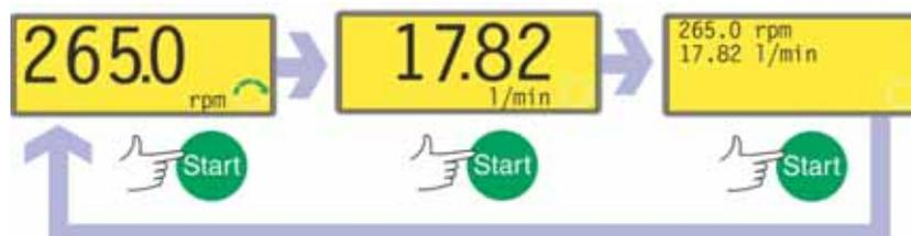
Se a bomba estiver funcionando quando **START** for pressionado, as informações exibidas na tela Manual running passam, na seqüência, para revoluções por minuto, vazão na unidade escolhida (através de uma tela de aviso se a vazão não foi calibrada e se este for o primeiro ciclo desde que a bomba foi ligada), rpm e vazão. Veja o exemplo dado. O padrão pode ser alterado no menu Setup (Veja 19.2 Visor).
