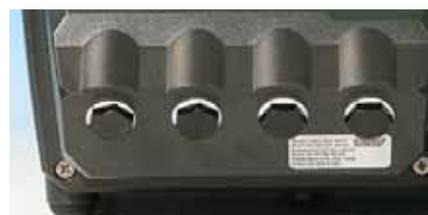
Condutores de cabos de controle recomendados para os blocos de terminais: sistema métrico = 0,14 mm<sup>2</sup> - 2,5 mm<sup>2</sup> sólido e 0,14 mm<sup>2</sup> - 1,5 mm<sup>2</sup> trançado. sistema USA = 26 AWG - 14 AWG sólido e 26 AWG - 16 AWG trançado. Cabo: circular. Diâmetro externo máx/mín que garanta vedação quando passado através do passa-cabos padrão: 9,5 mm - 5 mm. **A seção do cabo deve ser circular, para assegurar a vedação.**
