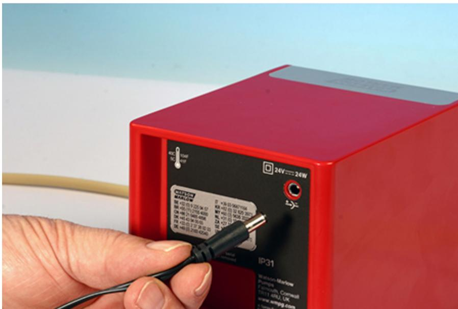
A bomba é alimentada por uma fonte de alimentação CC de 24 V externa fornecida de fábrica. Conecte o conector de saída da alimentação elétrica à tomada na parte posterior da bomba.
