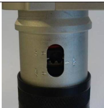
Tournez la tête de capsulage jusqu'à ce que la plaque de réglage soit visible à travers la fente.
