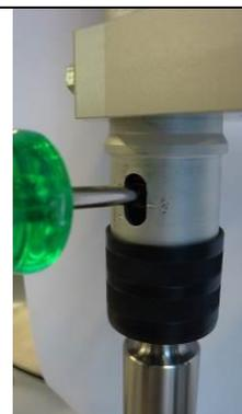
Insérez un tournevis et régler le couple en tournant dans un sens ou dans l'autre.
