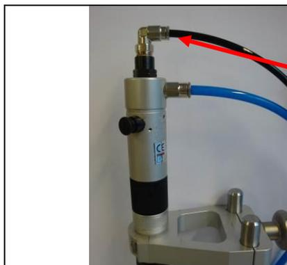
Retirez le tuyau d'air et versez une goutte d'huile dans le port d'admission d'air.
