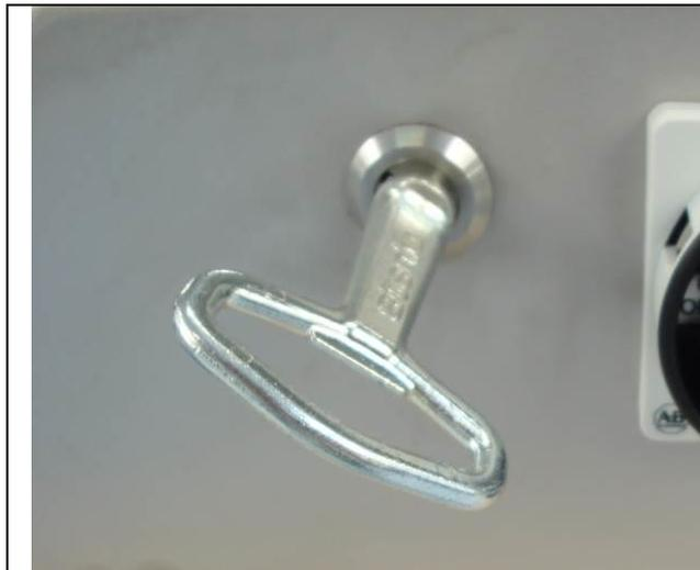
L'armoire inférieure s'ouvre à l'aide d'une clé. Des orifices prévus à cet effet sont placés de chaque côté de la machine.
