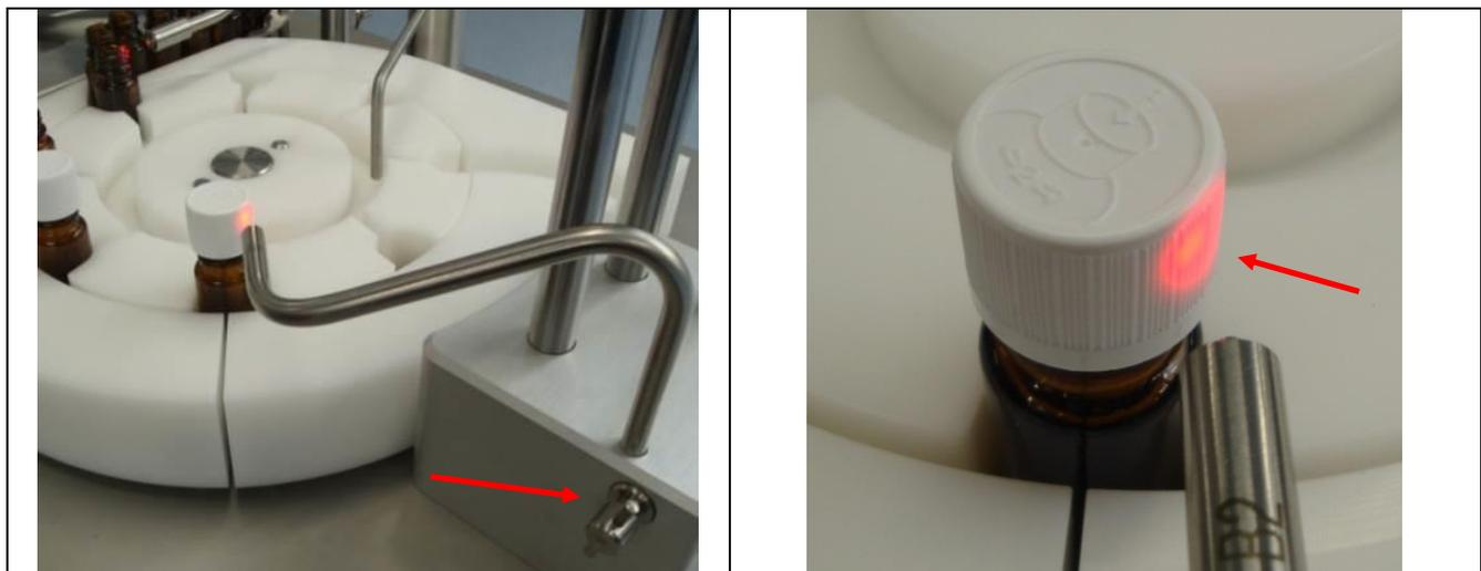
Placez un flacon devant le capteur, avec un bouchon posé sur le flacon.
