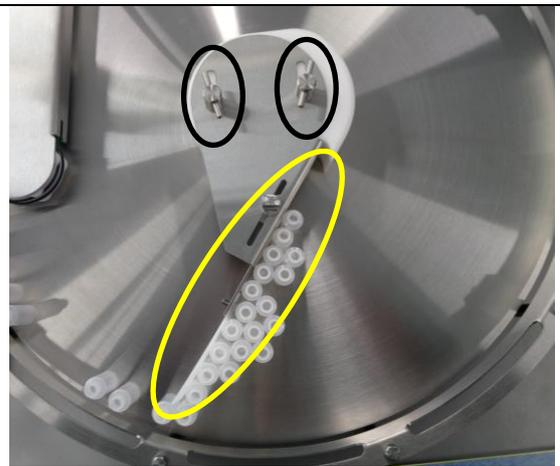
Pour le montage de l'embout flexible du guide intérieur, voir: 4.1.3 - Installation de l'embout flexible du guide-bouteille intérieur.
