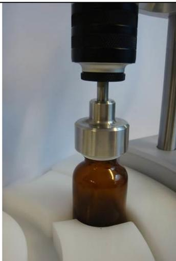
Placez sous l'unité de capsulage un flacon avec son bouchon. Vissez le bouchon de sorte qu'il soit serré au couple souhaité.
