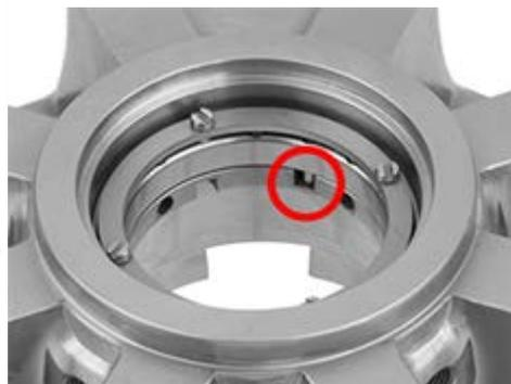
El ensamble de resortes bien instalado en la parte trasera de la carcasa posterior.
