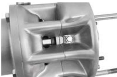
Conecte todas las demás conexiones posibles a la caja usando los tapones roscados suministrados con la bomba (consulte los números de parte en "Listas de piezas" en la página 52 ). Las demás conexiones están diseñadas para usar con distintas orientaciones de las boquillas de la bomba (consulte "Orientaciones posibles de la bomba" en la página 19).
