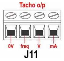
**Nota**: Si la salida de mA se va a usar para realizar lecturas con un polímetro, es necesario instalar una resistencia de  $250\,\Omega$  en serie.
