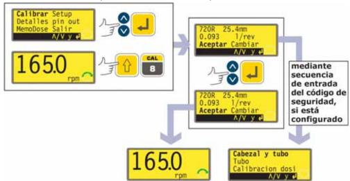
Use las teclas ARRIBA y ABAJO para resaltar Calibración en el menú principal. Presione la tecla ENTER para confirmar.
