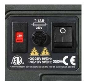
**Fusible de línea de entrada**: fusible retardado del tipo T5A H, de 250 V y 20 mm, ubicado en un portafusible en el centro de la placa de conmutación en la parte posterior de la bomba.
