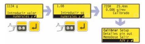
**Nota**: Si la bomba se ha configurado para mostrar el caudal en unidades de masa (véase la sección 18.8, Unidades de caudal), como en este ejemplo, la bomba muestra una pantalla que permite al usuario confirmar la densidad del fluido inmediatamente antes de presionar finalmente **ENTER**.
