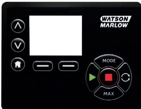
4. Cuando se activa una banda de alarma, la bomba muestra la pantalla "Sensor Alarm Detected" (Alarma de sensor detectada) y la bomba se detiene.
