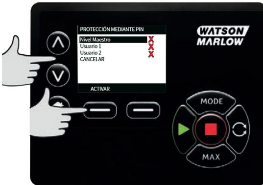
2. **LA OPCIÓN HABILITAR** la configuración de seguridad del Usuario 1 muestra la pantalla de ingreso del PIN para el Usuario 1. Para definir un PIN de cuatro dígitos para el Usuario 1, use las teclas  $\wedge$  /  $\vee$  para seleccionar dígitos del 0 al 9. Tras ingresar el dígito deseado, pulse la tecla **DÍGITO SIGUIENTE**.
