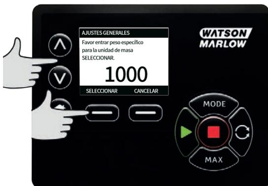
3. Use las teclas  $\wedge$  /  $\vee$  para ingresar el valor de peso específico y pulse **SELECCIONAR**.
