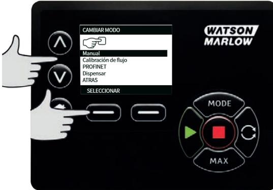
2. Con las teclas  $\wedge$  /  $\vee$ , desplácese hasta **DISPENSAR** y pulse **CONFIGURACIÓN**
