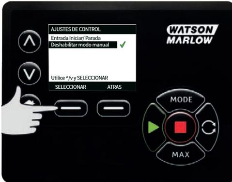
2. Use las teclas  $\wedge$  /  $\vee$  y pulse **SELECCIONAR** para elegir el estado lógico de la entrada escogida para su equipo de control conectado.
