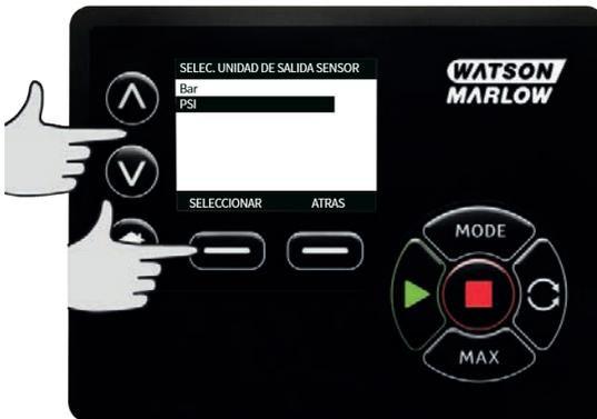
8. Con las teclas  $\wedge$  /  $\vee$ , desplácese hasta el sensor deseado y pulse **SELECCIONAR**.
