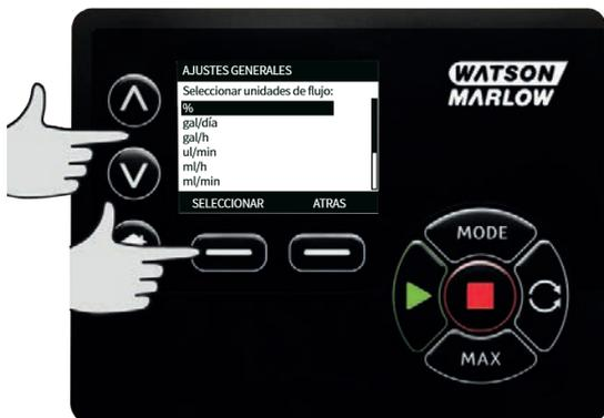
2. Si se selecciona una unidad de caudal de masa, debe ingresar la gravedad específica del fluido. Se muestra la siguiente pantalla:
