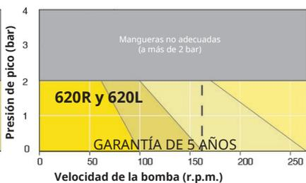
**Figura 21 - Presión de bombeo de 0-2 bar**
