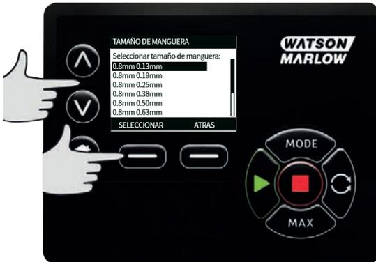
3. Si se ha seleccionado un elemento LoadSure, entonces el tamaño de la manguera se muestra como presión y diámetro.
