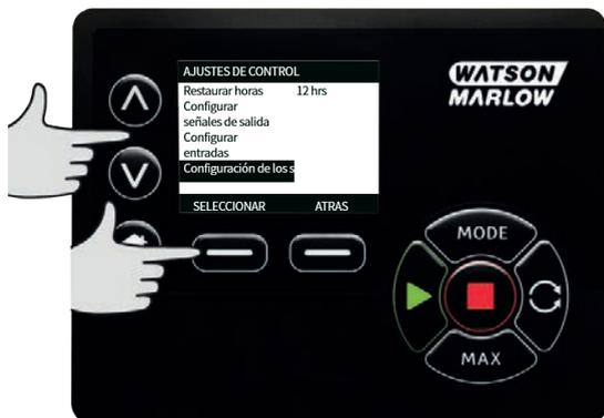
2. Con las teclas  $\wedge$  /  $\vee$ , desplácese hasta la opción **Configurar sensores** y pulse **SELECCIONAR**.
