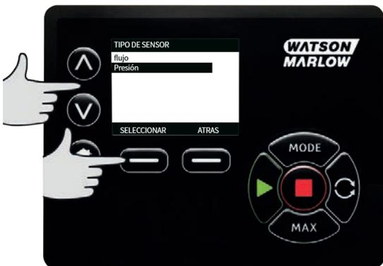
4. Con las teclas  $\wedge/\vee$ , desplácese hasta la opción **Sensor genérico de caudal** o **Sensor genérico de presión** y pulse **SELECCIONAR**.
