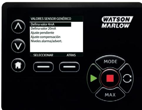
2. Con las teclas  $\wedge/\vee$ , desplácese hasta **Ajuste definido de inclinación**
