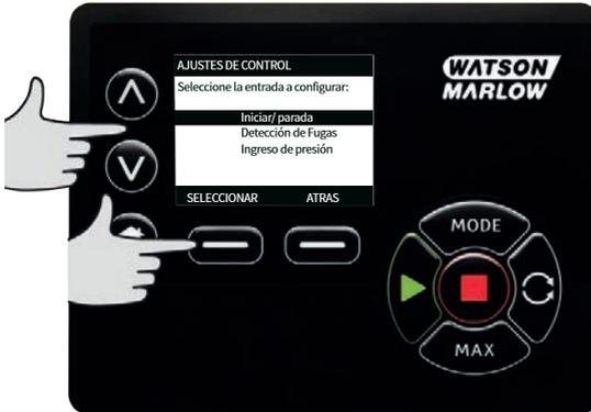
3. Use las teclas  $\wedge$  /  $\vee$  y pulse **SELECCIONAR** para elegir el estado lógico de la entrada escogida.
