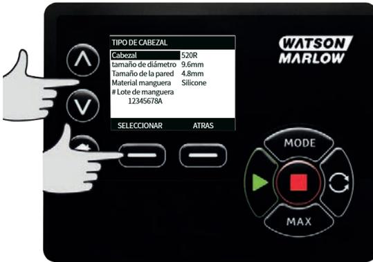
2. Use las teclas  $\wedge$  /  $\vee$  para mover la barra de selección sobre el tamaño de la manguera y pulse **SELECCIONAR**.
