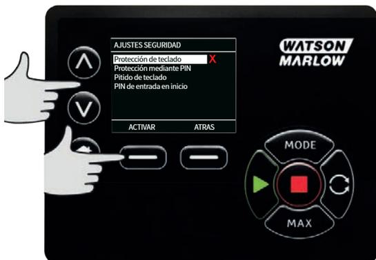
2. Una vez bloqueado, mostrará la siguiente pantalla al pulsar cualquier tecla. Para desbloquear el teclado, pulse las dos teclas **DESBLQUEAR** juntas.
