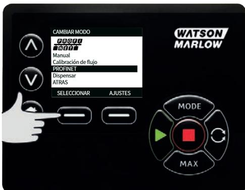
4. Pulse la tecla **CONFIGURACIÓN** para acceder al menú **PROFINET® CONFIGURACIÓN**.
