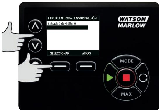
6. Con las teclas  $\wedge/\vee$ , seleccione el tipo de salida del sensor y pulse **SELECCIONAR**. La tabla siguiente muestra las opciones según el tipo de sensor.
