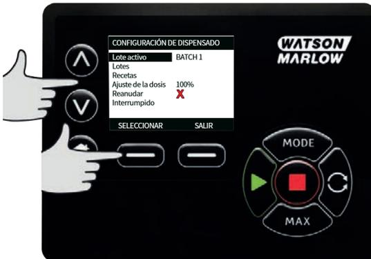
4. Con las teclas  $\wedge$  /  $\vee$ , desplácese hasta **Agregar receta nueva** y pulse **SELECCIONAR** para crear una nueva receta. Aparece la pantalla **AGREGAR RECETA**. De manera alternativa, desplácese hasta el nombre de una receta y pulse **SELECCIONAR** para editar esa receta. Aparece la pantalla **EDITAR RECETA**.
