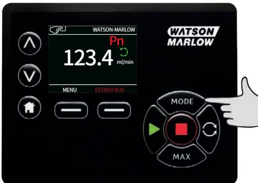
2. Con las teclas  $\wedge$  /  $\vee$ , desplácese hasta **Dispensado** y pulse **CONFIGURACIÓN**
