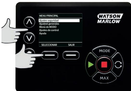
2. Use las teclas  $\wedge$  /  $\vee$  para mover la barra de selección sobre el **Tipo de cabezal** y pulse **SELECCIONAR**. Aparecerá la siguiente pantalla.
