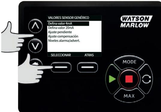
3. Con las teclas  $\wedge/\vee$ , seleccione el valor que desea cambiar y pulse **SELECCIONAR**.
