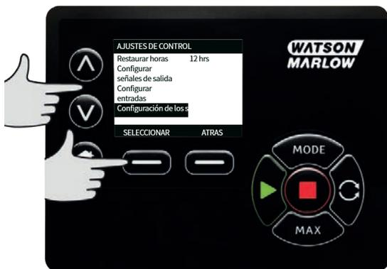
2. En el menú de configuración de control, con las teclas  $\wedge$  /  $\vee$ , desplácese hasta la opción **Definir el retardo del sensor** y pulse **SELECCIONAR**
