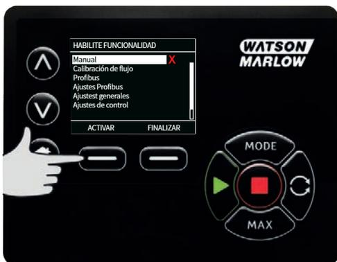
Una vez que el maestro haya establecido los ajustes de seguridad para el Usuario 1 y el Usuario 2, solo el PIN maestro permitirá el acceso a los ajustes de seguridad.
