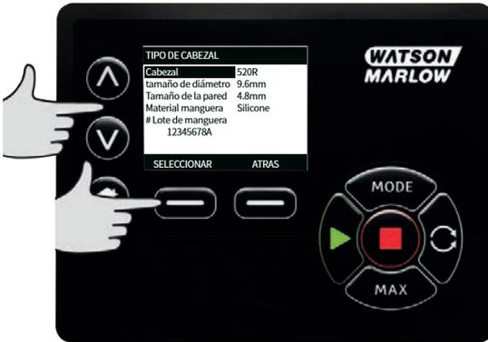
4. Use las teclas  $\wedge$  /  $\vee$  para mover la barra de selección sobre el tipo de cabezal requerido y pulse **SELECCIONAR**.
