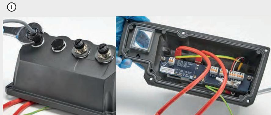
Puesta a tierra de los cables de control conectados al terminal de tierra (J6) en el adaptador PCB cuando se usa un prensaestopas de plástico.
