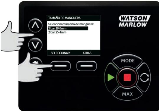
4. Esta pantalla también le permite seleccionar el material de la manguera a usar. Use las teclas  $\wedge$  /  $\vee$  para mover la barra de selección sobre **Materiales de las mangueras** y pulse **SELECCIONAR**.
