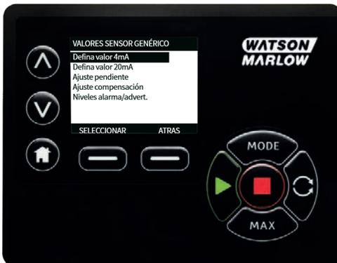
2. Con las teclas  $\wedge$ / $\vee$ , desplácese hasta **Ajuste definido de compensación**
