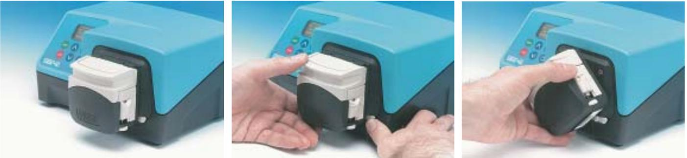
Empujar hacia atrás la palanca de bloqueo y hacer girar el cabezal de la bomba en el sentido contrario al de las agujas del reloj hasta que quede libre de la placa de montaje.
