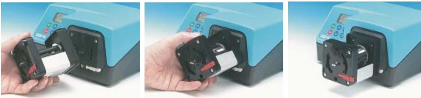
Acoplar la ranura del accionamiento del cabezal de bomba con el extremo del eje del accionamiento de la bomba. Continuar alineando el cabezal de bomba hasta que la bayoneta quede acoplada con la placa de montaje. Hacer girar el cabezal de bomba hasta que quede bloqueado en una posición vertical.
