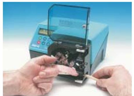
El rotor tiene rodillos de guía del tubo que estiran el tubo dentro del cabezal de la bomba durante la carga. Gire el rotor cuidadosamente hasta que las guías del tubo lo sujeten. Continúe girando el rotor, y alimente la tubería hacia dentro entre las guías.
