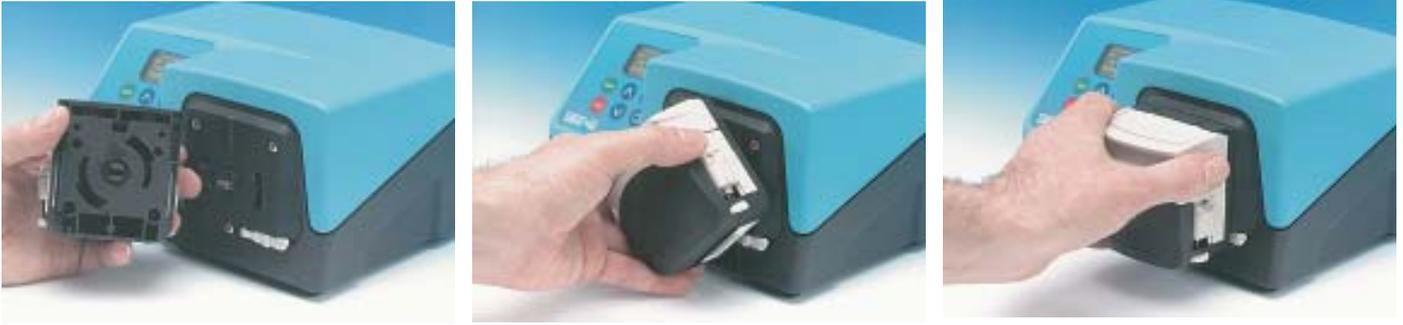
Acoplar la ranura del accionamiento del cabezal de bomba con el extremo del eje del accionamiento de la bomba. Continuar alineando el cabezal de bomba hasta que la bayoneta quede acoplada con la placa de montaje. Hacer girar el cabezal de bomba en sentido horario hasta que quede bloqueado en una posición vertical.
