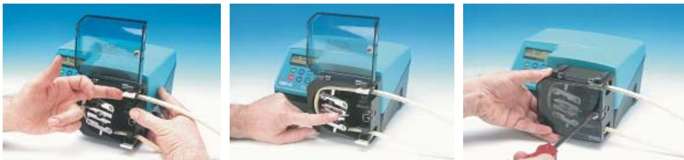
Las mordazas del tubo pueden ajustarse a varios diámetros de tubo empujando o estirando las barras de sujeción dentro de la mordaza. Ajuste las mordazas para aplicar la mínima presión necesaria al tubo.
