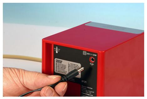
La bomba recibe alimentación de un suministro externo especial de 24 V de CC, que viene provisto con la bomba.
