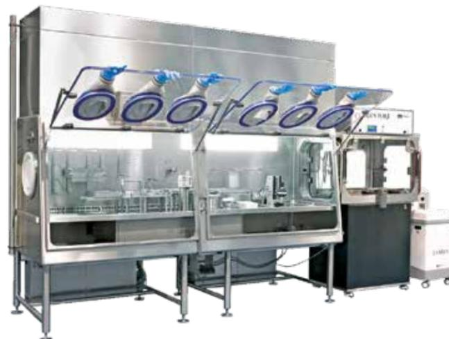
Un système FP50 personnalisé est intégré à un isolateur pour que le liquide et les flacons remplis soient entièrement contenus.
