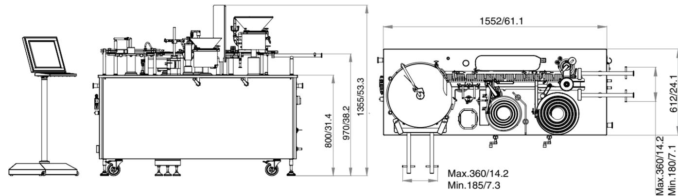
Dimensions en mm/pouce Dans ce dessin, le système est équipé de l'option de contrôle du poids en ligne. Le plateau d'entrée peut se monter à l'avant ou sur le côté gauche de la machine, tandis que la FPC50 peut être personnalisée en vue d'être intégrée à une unité RABS ou à un isolateur
