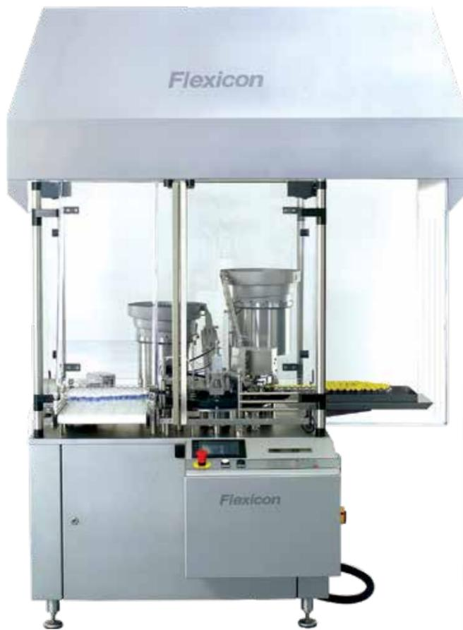
Ci-dessus : unité FMB210 avec tente à flux d'air laminaire.
