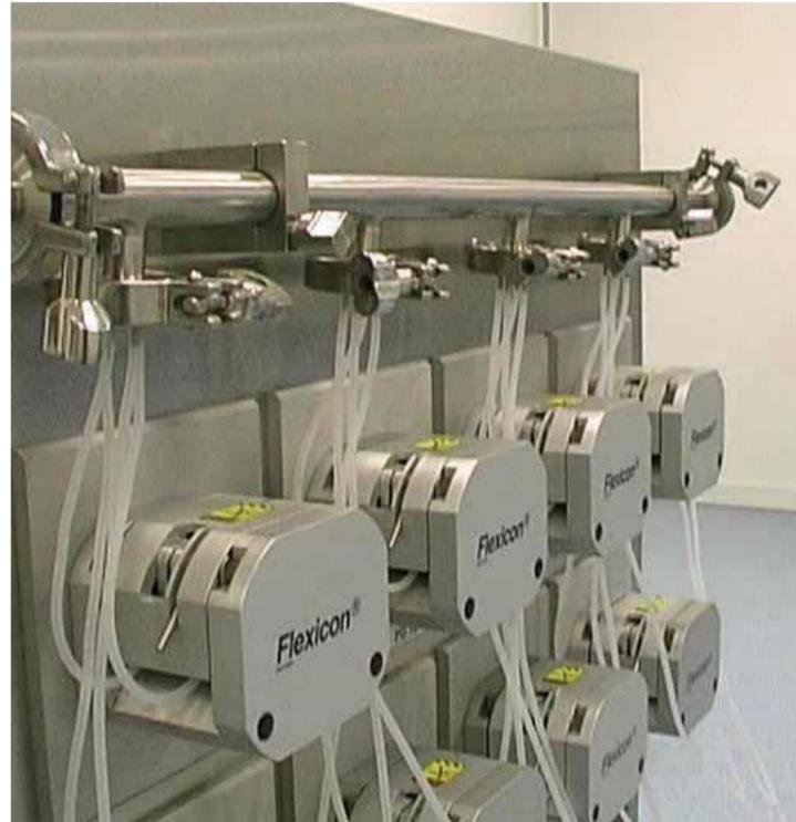
Les solutions sur chariot sont fournies pour intégration aux lignes de remplissage nouvelles ou existantes, équipées d'une à seize machines de remplissage péristaltique
