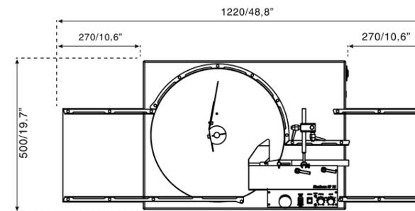
Dimensions en mm/pouce Sur les modèles FlexFeed20 et FlexFeed15, le plateau d'entrée peut être aisément monté à l'avant ou sur le côté gauche de la machine.
