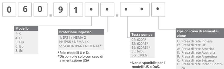
\*Modulo speciale NEMA 069.911F.100 Modulo a tenuta stagna Ethernet (630F) IP66 NEMA 4X è richiesto per il sensore di portata KROHNE, abbinato alla pompa IP31
