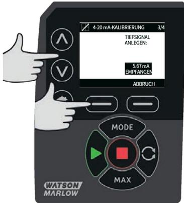
Wenn der Bereich zwischen dem Nieder- und Hochpegelsignal unter 1,5 mA liegt, wird die folgende Fehlermeldung angezeigt.
