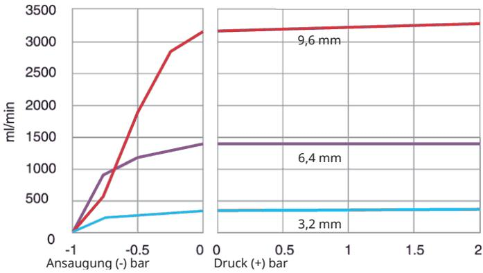
**Marprene TM-Element, 2-4 bar, 200 U/min, Drehung entgegen dem Uhrzeigersinn**
