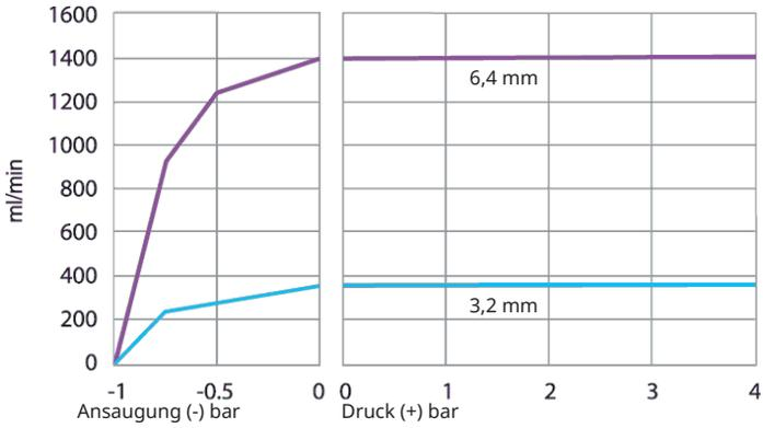
**Marprene TH-Element, 4-7 bar, 200 U/min, Drehung entgegen dem Gegenuhrzeigersinn**
