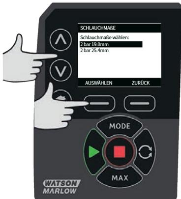
In diesem Bildschirm kann ebenfalls ein Werkstoff für den eingesetzten Schlauch bestimmt werden.
