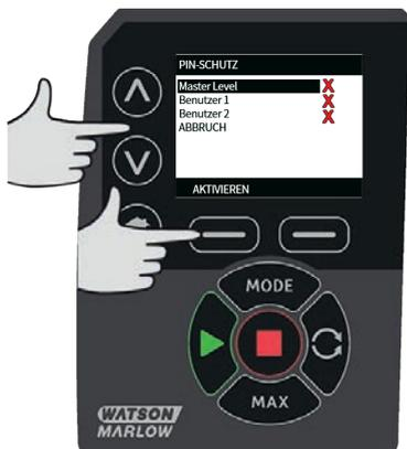
Über die Tasten  $\wedge$  /  $\vee$  eine vierstellige Master-PIN aus den Ziffern 0-9 eingeben. Nach Eingabe einer Ziffer auf **NÄCHSTE ZIFFER** drücken. Nach der vierten Ziffer auf **EINGABE** drücken.
