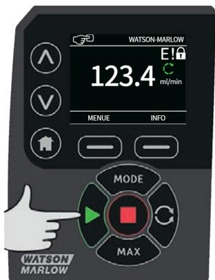
Startet die Pumpe mit der angezeigten aktuellen Fördermenge, und ändert den Hintergrund der Anzeige in grau. Hat keine Auswirkung, wenn die Pumpe bereits in Betrieb ist.
