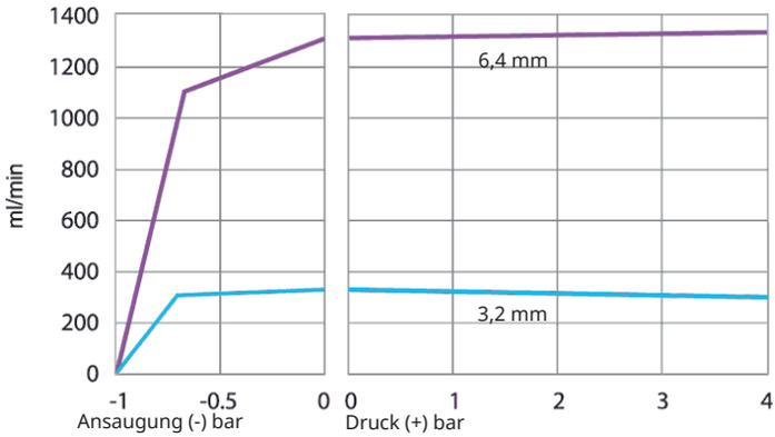
**Sta-Pure-Element, 2 - 4 bar,(0 - 60 psi), 200 U/min, Drehung entgegen dem Uhrzeigersinn**
