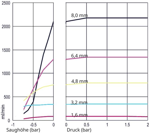
**Marprene-Schläuche, 2,4 mm Wandstärke, 200 U/min, Drehung im Uhrzeigersinn**
