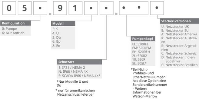
\*Spezielles NEMA-Modul 059.911.F.100 Ethernet Wasserdichtes Modul (530F) IP66 NEMA 4X ist für den KROHNE-Durchflusssensor in Kombination mit der IP31-Pumpe erforderlich
