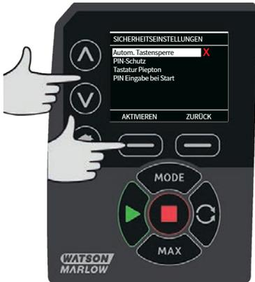
Nach erfolgter Sperrung erscheint bei Betätigung einer Taste nachstehender Bildschirm. Zum Entsperren des Tastenfeldes beide Tasten **ENTSPERREN** gleichzeitig drücken.
