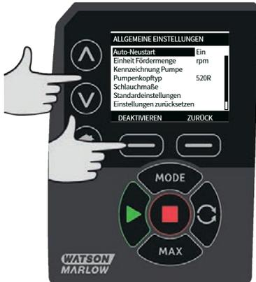
Über die  $\wedge$ / $\vee$  Tasten den Auswahlbalken auf **Pumpenkopftyp** bewegen und auf **AUSWÄHLEN** drücken.
