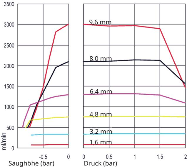
**Marprene-Schläuche, 2,4 mm Wandstärke, 200 U/min, Drehung entgegen dem Uhrzeigersinn**
