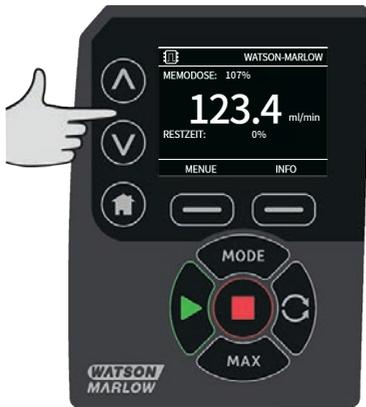
Wenn während des Dosierens **STOP** gedrückt wird, hält die Pumpe an. Über **START** wird die abgebrochene Dosierung wieder aufgenommen oder verworfen, je nach Einstellung in "Unterbrochene Dosierung fortsetzen" auf Seite 76.
