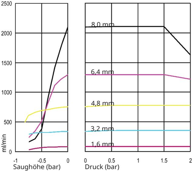
**Marprene-Schläuche, Wandstärke 1,6mm , 200 U/min, Drehung entgegen dem Uhrzeigersinn**
