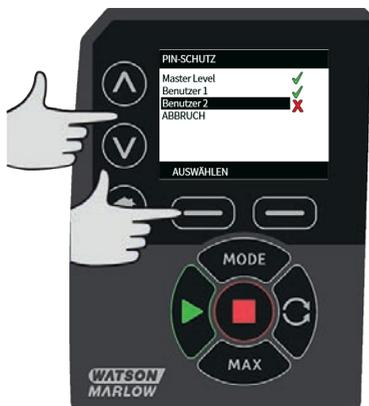
Über Sicherheitseinstellungen Benutzer 2 **AKTIVIEREN** wird der PIN-Eingabebildschirm für Benutzer 2 aufgerufen. Über die Tasten  $\wedge$  /  $\vee$  eine vierstellige PIN aus den Ziffern 0-9 für Benutzer 2 eingeben. Nach Eingabe einer Ziffer auf **NÄCHSTE ZIFFER** drücken. Nach der vierten Ziffer auf **EINGABE** drücken.
