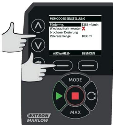
Über die  $\wedge$   $\vee$  Tasten die zu dosierende Fördermenge eingeben und auf **AUSWÄHLEN** drücken.
