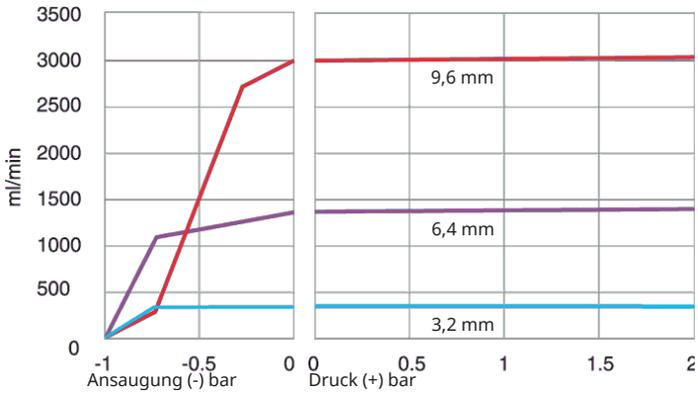
**Sta-Pure - Element, 0 - 2 bar, (0 - 30 psi), 200 U/min, Drehung entgegen dem Uhrzeigersinn**
