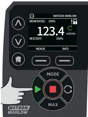
Wenn die abgegebene Dosiermenge vom gewünschten Volumen abweicht, kann der Prozentsatz im Bereich von 50% bis 150% der Referenzmenge (Master-Dosis) angepasst werden. Über die  $\wedge$ / $\vee$  Tasten lässt sich der Prozentsatz ändern. Der neue Wert der Dosiermenge wird als Prozentsatz am Startbildschirm angezeigt.
