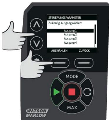
Über die  $\wedge$  /  $\vee$  Tasten auf **AUSWÄHLEN** gehen und den für den gewählten Ausgang gewünschten Status der Pumpe bestimmen. Der Haken zeigt die aktuelle Einstellung an.
