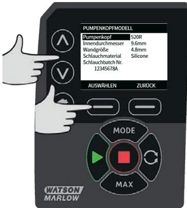
Über die  $\wedge$  /  $\vee$  Tasten den Auswahlbalken auf den gewünschten Schlauchwerkstoff bewegen und auf **AUSWÄHLEN** drücken.
