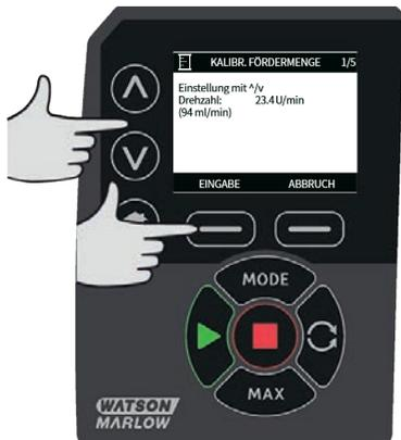
Auf **START** drücken, um ein Volumen an Flüssigkeit für die Kalibrierung zu pumpen.
