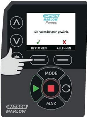
3. Mit **ABLEHNEN** können Sie zum Menü Sprachauswahl zurückgehen. Anschließend kehren Sie zur Ausgangsseite zurück.
