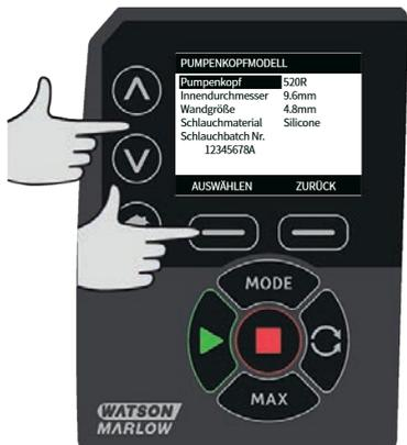
Über die  $\wedge$  /  $\vee$  Tasten den Auswahlbalken auf die gewünschte Schlauchgröße bewegen und auf **AUSWÄHLEN** drücken.
