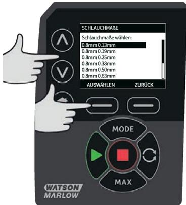
Bei LoadSure Schlauchelementen wird unter Schlauchgröße der Druck und der Innendurchmesser angezeigt.
