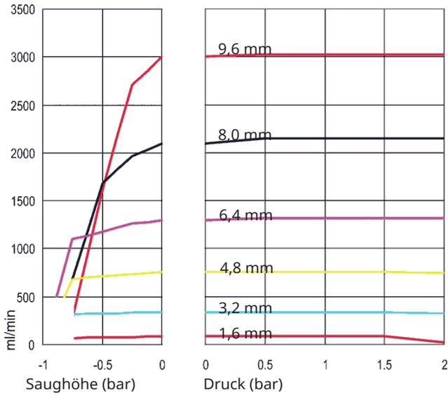
**Marprene TL-Element, 0 - 2 bar, (0 - 30 psi), 200 U/min, Drehung entgegen dem Uhrzeigersinn**
