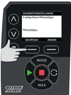
Zur Bestätigung, dass die Master-PIN für den Zugriff auf alle Funktion eingerichtet worden ist, erscheint folgender Bildschirm. Auf **VOR** drücken, um bestimmte Funktionen für den Zugriff durch Benutzer 1 und Benutzer 2 zu aktivieren.
