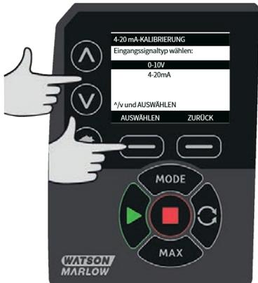
Die Hoch- oder Niederpegelsignale mA bzw. V Signale können wahlweise manuell oder über den analogen Eingang der Pumpe eingegeben werden. Die Eingabe der mA Werte wird hier beschrieben, wobei der Ablauf für die Eingabe der V Signale identisch ist.
