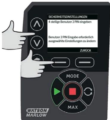
Über die  $\wedge$  /  $\vee$  Tasten die zuzuordnenden Funktionen bestimmen und mit **AKTIVIEREN** bestätigen. Mit der PIN des Benutzers 2 ist ein Zugriff nur auf die zugeordneten Funktionen möglich. Zur Deaktivierung die aktivierten Funktionen markieren und auf **DEAKTIVIEREN** drücken. Nach Aktivierung aller benötigten Funktionen auf **FERTIG** drücken.
