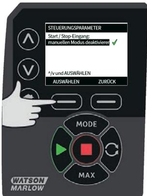
Verwenden Sie die  $\wedge$  /  $\vee$  Tasten und drücken Sie auf **AUSWÄHLEN**, um den Logikstatus für die verbundene Steuerhardware bestimmen.
