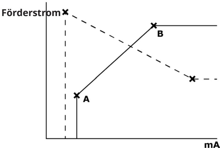
Wenn das empfangene Analogsignal über dem für Punkt A definierten Wert liegt, wird der Start/Status-Ausgang bei laufender Pumpe angesteuert.
