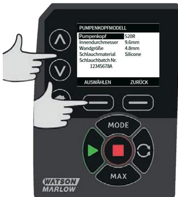
Über die  $\wedge$  /  $\vee$  Tasten den Auswahlbalken auf den gewünschten Pumpenkopf bewegen und auf **AUSWÄHLEN** drücken.
