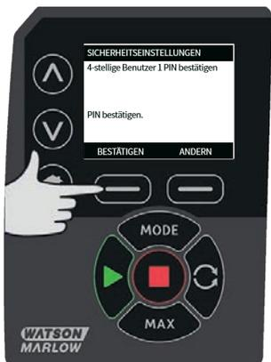
Über die  $\wedge$  /  $\vee$  Tasten die zuzuordnenden Funktionen bestimmen und mit **AKTIVIEREN** bestätigen. Mit der PIN des Benutzers 1 ist ein Zugriff nur auf die zugeordneten Funktionen möglich. Zur Deaktivierung die aktivierten Funktionen markieren und auf **DEAKTIVIEREN** drücken. Nach Aktivierung aller benötigten Funktionen auf **FERTIG** drücken.
