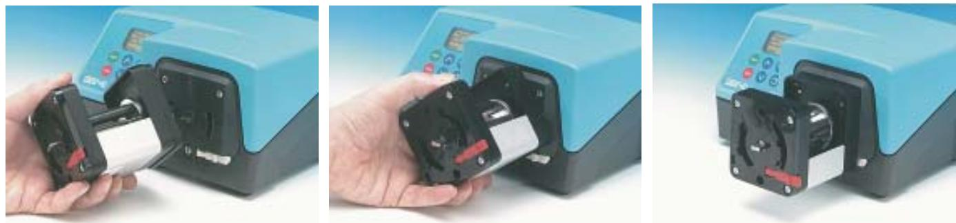
Inserire nella scanalatura di azionamento della testina l'estremità dell'albero di azionamento della pompa. Continuare ad allineare la testina fino a innestare la baionetta con la piastra di montaggio. Ruotare la testina fino a bloccarla in posizione verticale.
