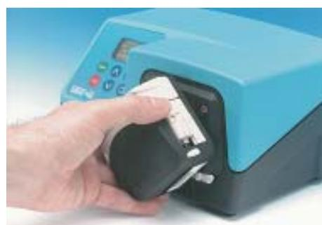
Spingere indietro la leva di bloccaggio e ruotare la testina in senso antiorario fino a liberarla dalla piastra di montaggio.
