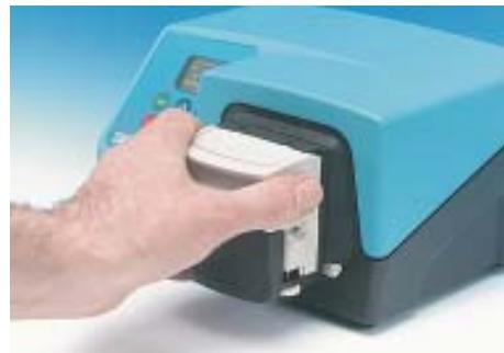
Inserire nella scanalatura di azionamento della testina l'estremità dell'albero di azionamento della pompa. Continuare ad allineare la testina fino a innestare la baionetta con la piastra di montaggio. Ruotare la testina in senso orario fino a bloccarla in posizione verticale.
