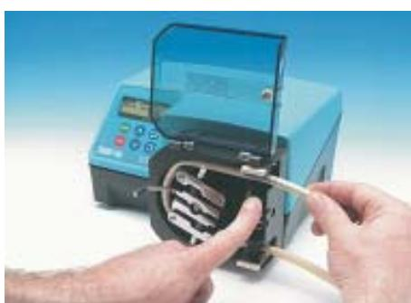
Una volta che il tubo è passato attorno al corpo testina della pompa inserire l'altra estremità del tubo nel morsetto.
