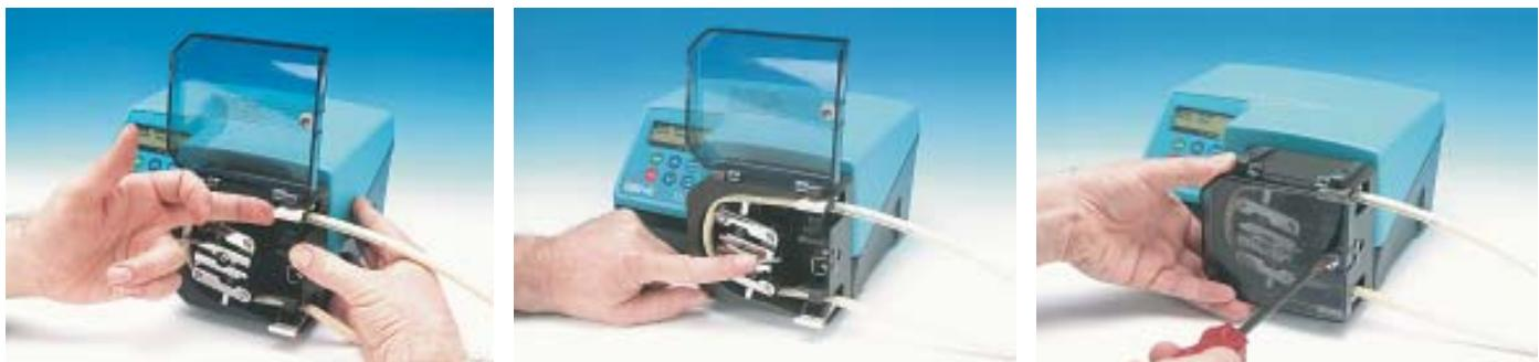
I morsetti del tubo possono accettare vari diametri di tubo spingendo in dentro o tirando in fuori le barre di presa all'interno del morsetto. Regolare i morsetti in modo che applichino la pressione minima necessaria al tubo.
