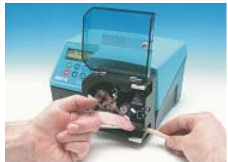
Il rotore ha dei rulli di guida del tubo che tirano il tubo nella testina durante il caricamento. Ruotare con cura il rotore fino a che le guide non afferrino il tubo. Continuare a ruotare il rotore e alimentare il tubo tra le guide.
