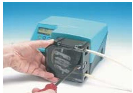
Die Schlauchklemmen sind für verschiedene Schlauchdurchmesser geeignet. Zur Anpassung dienen Griffschienen, die sich einschieben und herausziehen lassen. Die Schlauchklemmen so einzustellen, dass der Druck auf den Schlauchs möglichst gering ist.
