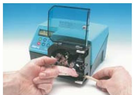
Am Rotor befinden sich Schlauchführungsrollen, die den Schlauch während des Einlegens in den Pumpenkopf einziehen. Rotor vorsichtig drehen, bis der Schlauch von den Schlauchführungen erfasst wird. Den Rotor weiter drehen und den Schlauch zwischen Druckrollen und Führungsbahn einführen.
