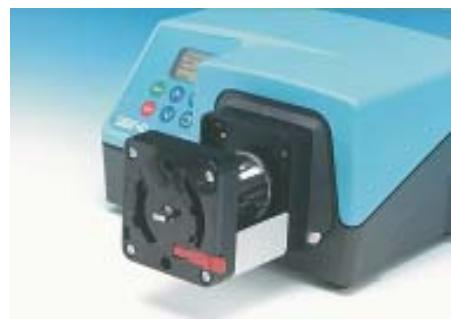
Die Antriebswelle der Pumpe in den Antriebsschlitz des Pumpenkopfs einführen. Den Pumpenkopf so ausrichten, dass die Bajonettkupplung in die Grundplatte greift. Pumpenkopf bis zum Einrasten in senkrechter Stellung drehen.
