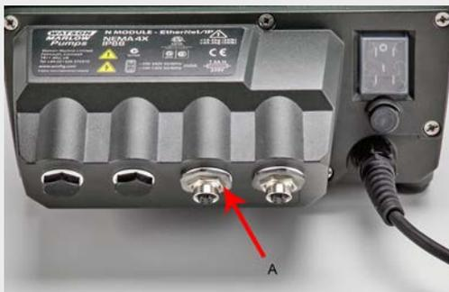
1. Par défaut, le corps et le blindage du câble des connecteurs Ethernet M12 sont isolés du corps métallique du module NEMA et de la terre du secteur. Ceci est conforme aux normes d'utilisation EtherNet/IP™ dans les systèmes d'automatisation industrielle utilisant EtherNet/IP™.
