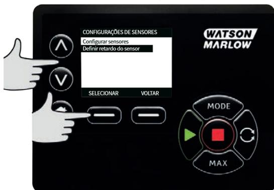
3. Usando as teclas  $\wedge$   $\vee$ , role até a opção **Vazão** ou **Pressão** e pressione **SELECIONAR**. Isto seleciona o tipo de sensor para configurar.
