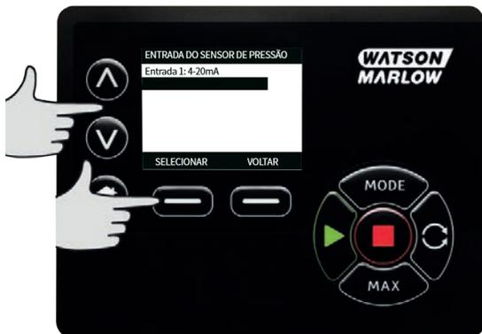
6. Usando as teclas  $\wedge$   $\vee$ , selecione o tipo de saída da unidade do sensor e pressione **SELECIONAR**. As opções na tabela abaixo dependem da escolha do tipo de sensor:
