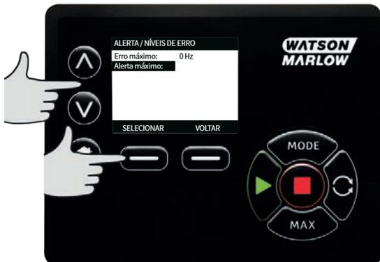
2. Usando as teclas  $\wedge$  /  $\vee$ , digite um valor e pressione **SELECIONAR** para armazenar. O padrão para todos eles é nenhum, visto que o usuário ajusta um valor na tela de edição e o aviso/alarme tornará ativo.
