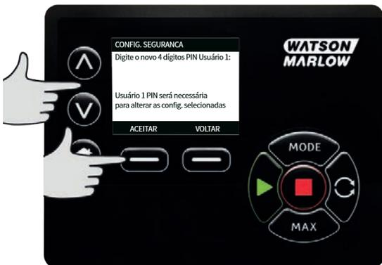
3. Em seguida, pressione **CONFIRMAR** para verificar que o número digitado é a senha requerida. Pressione **ALTERAR** para voltar à digitação da senha.
