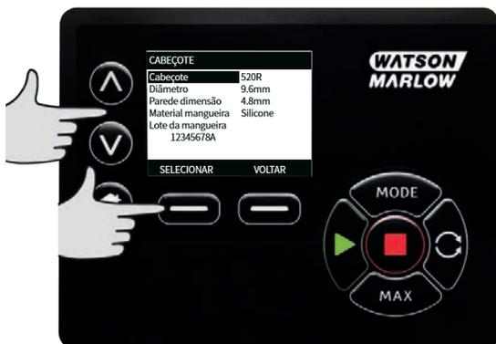
5. Use as teclas  $\wedge$  /  $\vee$  para ir até a barra de seleção acima do material de mangueira a ser usado e pressione **SELECIONAR**.
