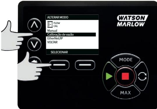
2. Usando as teclas  $\wedge$  /  $\vee$ , digite o limite máximo de vazão e pressione **ENTER**.
