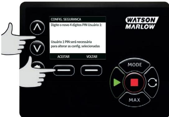
3. Em seguida, pressione **CONFIRMAR** para verificar que o número digitado é a senha selecionada. Pressione **ALTERAR** para voltar à digitação da senha.
