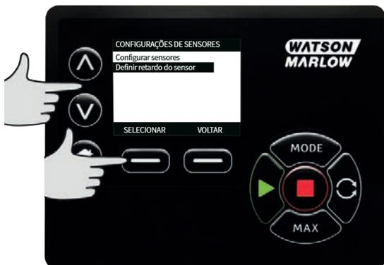
3. Usando as teclas  $\wedge$   $\vee$ , digite um valor e pressione **SELECIONAR** para armazenar.
