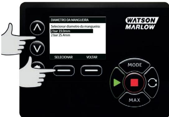
4. Essa tela permite ainda selecionar o material da mangueira utilizada. Use as teclas  $\wedge$  /  $\vee$  para ir até a barra de seleção acima do **Material da mangueira** e pressione **SELECIONAR**.
