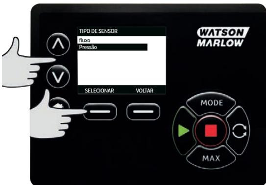
4. São exibidas uma lista de diversos sensores de vazão compatíveis. O exemplo na imagem acima mostra os sensores de vazão compatíveis. Usando as teclas  $\wedge$  /  $\vee$ , role até sensor de vazão desejado e pressione **SELECIONAR**.
