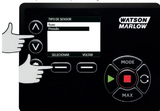
4. Usando as teclas  $\wedge$   $\vee$ , role até a opção **Sensor de vazão genérico** ou **Sensor de pressão genérico** e pressione **SELECIONAR**.
