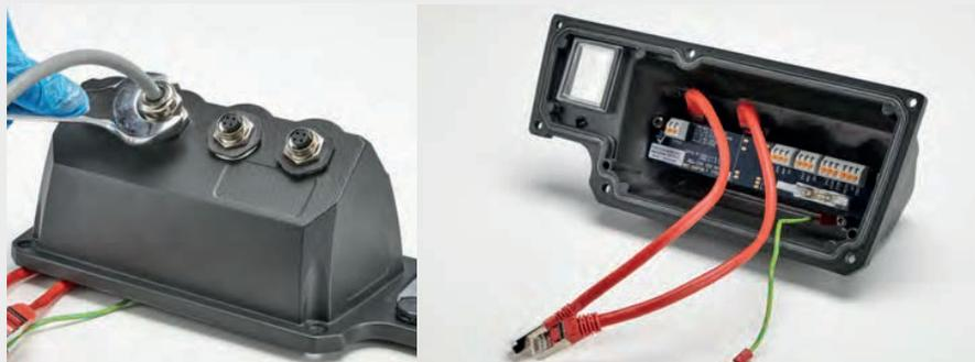
Nenhuma blindagem do terra dos cabos de controle é necessária quando o passa-cabo EMC é usado.
