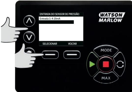
6. Usando as teclas  $\wedge$  /  $\vee$ , role até sensor de vazão desejado e pressione **SELECIONAR**.
