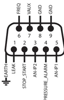
**Figura 16 - Fiação do conector-D do sensor de 9 vias**
