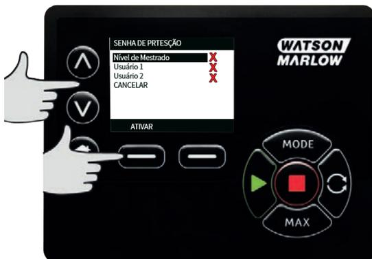
2. Para definir uma senha numérica Master de quatro dígitos, use as teclas  $\wedge$  /  $\vee$  para selecionar cada dígito entre 0 a 9. Após escolher o dígito, pressione a tecla **PRÓXIMO DÍGITO**. Depois de selecionar o quarto dígito, pressione **ENTER**.
