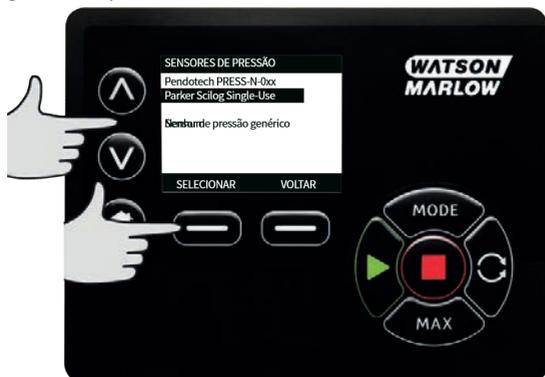
5. Usando as teclas  $\wedge$   $\vee$ , role até a opção **4-20mA entrada 1** ou **4-20mA entrada 2** e pressione **SELECIONAR**. Isso depende de qual conexão o usuário fez a ligação com o sensor. Consulte a seção "Fiação de controle EtherNet/IP™" Na página 24 para mais especificações de conexão. Somente os sensores genéricos que fornecem saída de 4-20 mA são compatíveis.
