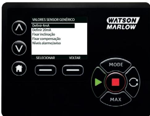
2. Usando as teclas  $\wedge$  /  $\vee$ , role até **Definir ajuste da inclinação**
