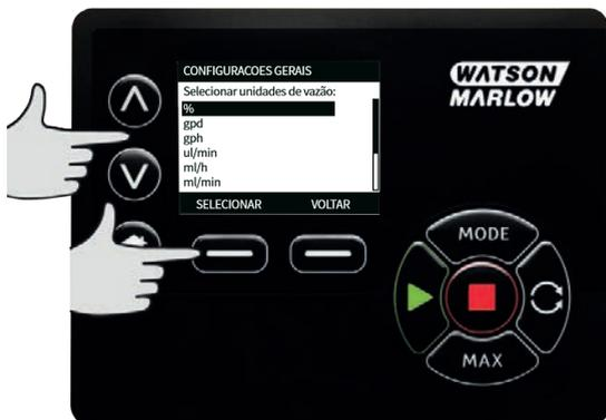
2. Se a unidade de vazão de massa for selecionada, a gravidade específica do fluido deverá ser informada. A seguinte tela será exibida:
