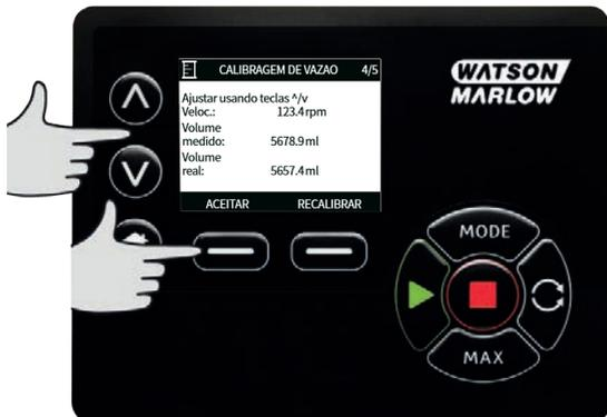
6. Para aceitar a nova calibração, pressione **ACEITAR** ou **RECALIBRAR** para repetir o procedimento. Pressione a tecla **HOME** ou **MODO** para cancelar.
