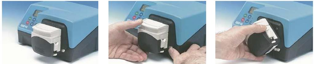
Poussez le levier de verrouillage vers l'arrière et tournez la tête de pompe dans le sens anti-horaire jusqu'à ce qu'elle se dégage de la plaque de montage.
