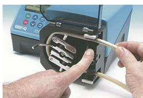
Lorsque le tube entoure le stator de la pompe, insérez son autre extrémité dans la pince. Assurez-vous que le tube est bien en place, naturellement, contre le stator, pour une durée de vie optimale. Relâchez les pinces et réglez les tubes si ils sont détendus, tordus ou étirés.
