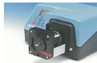
Engagez la fente d'entraînement de la tête de pompe sur l'extrémité de son arbre d'entraînement. Poursuivez l'alignement de la tête de pompe jusqu'à ce que la baïonnette s'engage dans la plaque de montage. Faites tourner la tête de pompe dans le sens horaire jusqu'à ce qu'elle se verrouille en position droite.
