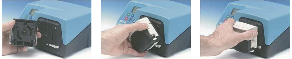
Engagez la fente d'entraînement de la tête de pompe sur l'extrémité de son arbre d'entraînement. Poursuivez l'alignement de la tête de pompe jusqu'à ce que la baïonnette s'engage dans la plaque de montage. Faites tourner la tête de pompe dans le sens horaire jusqu'à ce qu'elle se verrouille en position droite.
