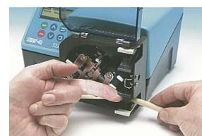
Le rotor comporte des galets de guidage de tube qui tirent le tube dans la tête de pompe pendant le chargement. Faites tourner le rotor avec précaution jusqu'à ce que les guides saisissent le tube. Continuez à faire tourner le rotor et insérez les tubes entre les guides.
